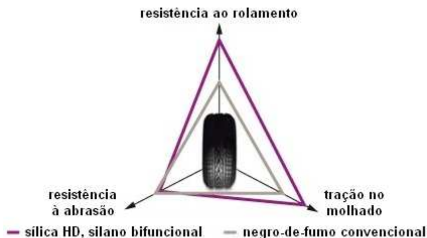
Figura 23: Comparação entre as características críticas de desempenho de pneus contendo sílica HD ou negro-de-fumo como carga reforçante no composto da banda de rodagem. 141
