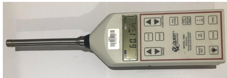
Figura 4.2 – Decibelímetro modelo 1900 da marca Quest Technologies utilizado para as medições.
