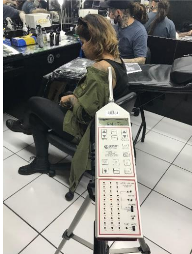
Figura 4.3 – Decibelímetro posicionado para leitura de nível de pressão sonora no ponto B.
