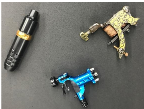
Figura 4.5 – Máquina de bobinas (cinza e dourada) e rotativa (azul) avaliadas neste estudo. Em preto o porta-agulhas comum às máquinas.
