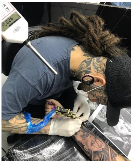
Figura 4.4 – Posição do decibelímetro adotada para mensuração do NPS para estimativa da dose diária de ruído.
