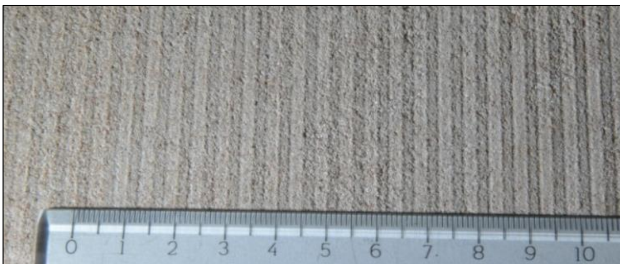
Figura 83 - Superfície do arenito após faceamento com broca diamantada, no final da vida útil, mostrando ondulações
