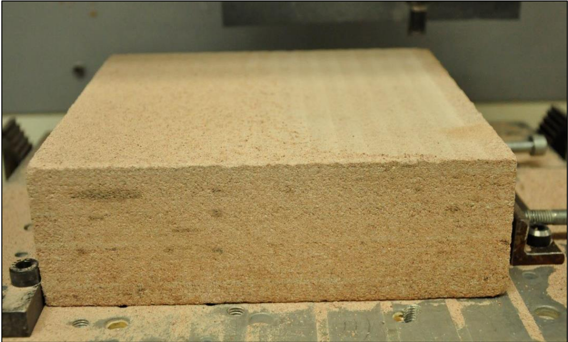
Figura 85 - Bloco de arenito quadrado de 200 x 200 mm após faceamento
