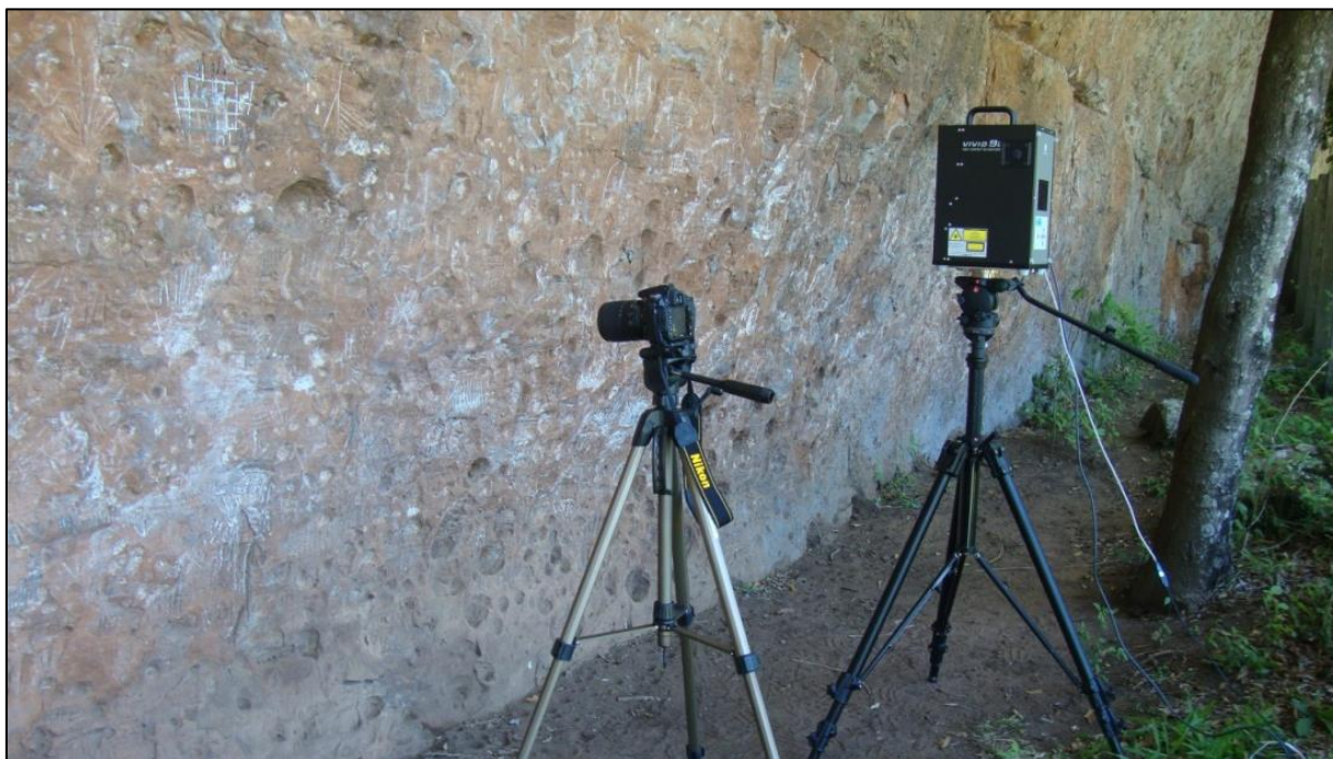
Figura 40 - Digitalização 3D da Pedra grande, câmera fotográfica e scanner 3D Vivid 9i
