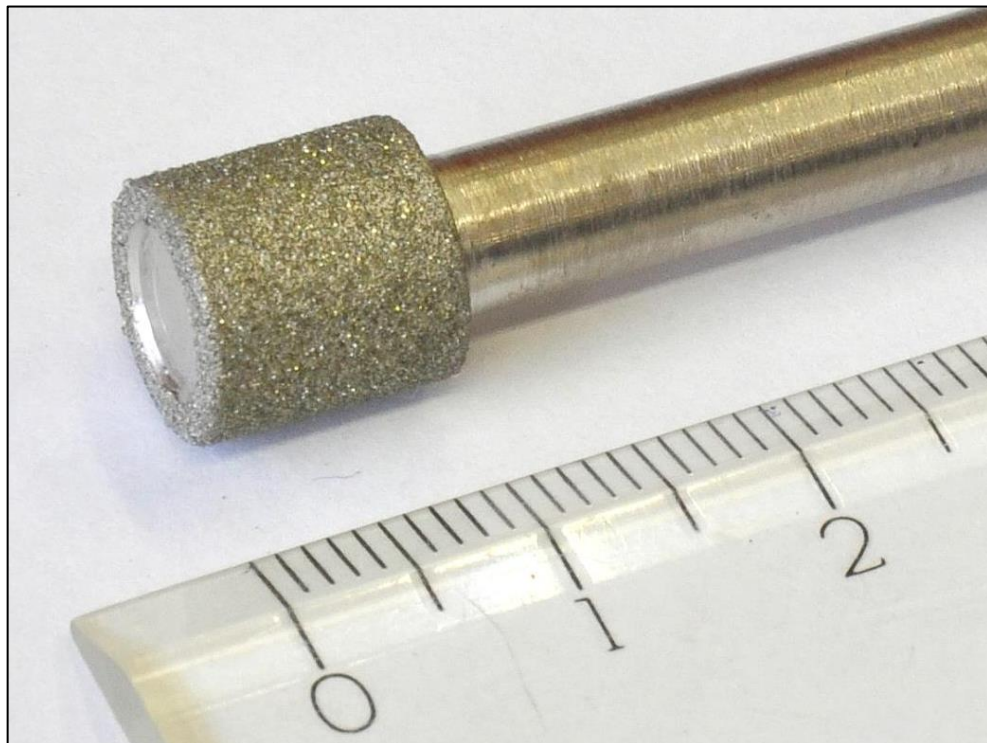
Figura 15 - Ferramenta diamantada por eletrodeposição de 10 mm de diâmetro Master Diamond PMD100/D126 8 , utilizada neste trabalho
