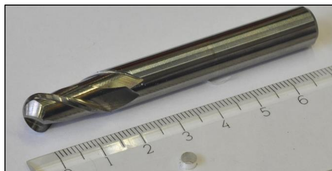
Figura 57 - Fresa inteira de metal duro de ponta esférica de 10 mm de diâmetro utilizada neste trabalho
