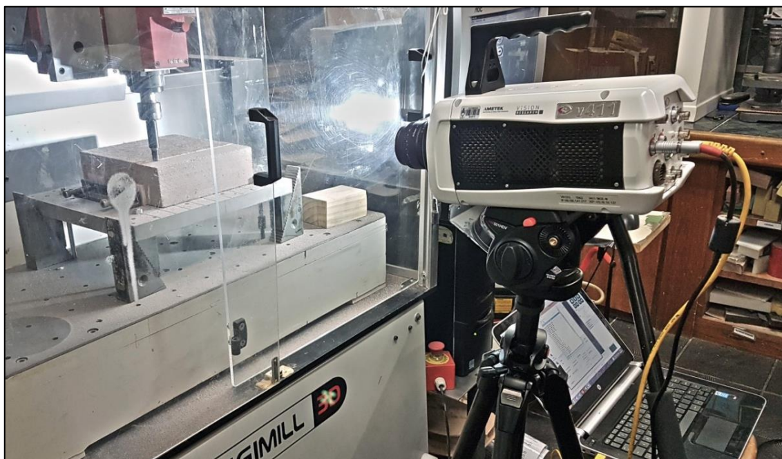
Figura 60 – Câmera de alta velocidade obtendo imagens da usinagem do arenito
