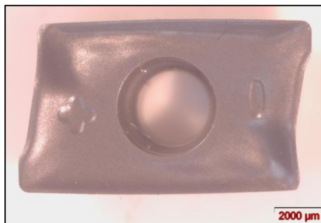
Figura 56 - Inserto intercambiável (pastilha) de Metal Duro utilizado na fresa de 12 mm de diâmetro
