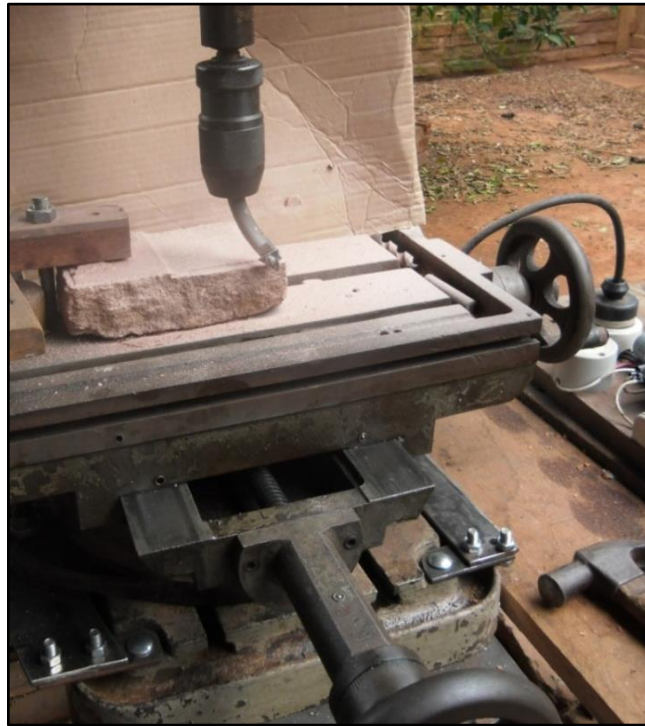
Figura 42 - Ensaio preliminares de usinagem do arenito em fresadora convencional
