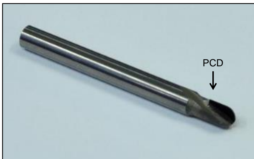
Figura 11 - Fresa de PCD, Wirutex, de ponta esférica de 6 mm de diâmetro, utilizada neste trabalho
