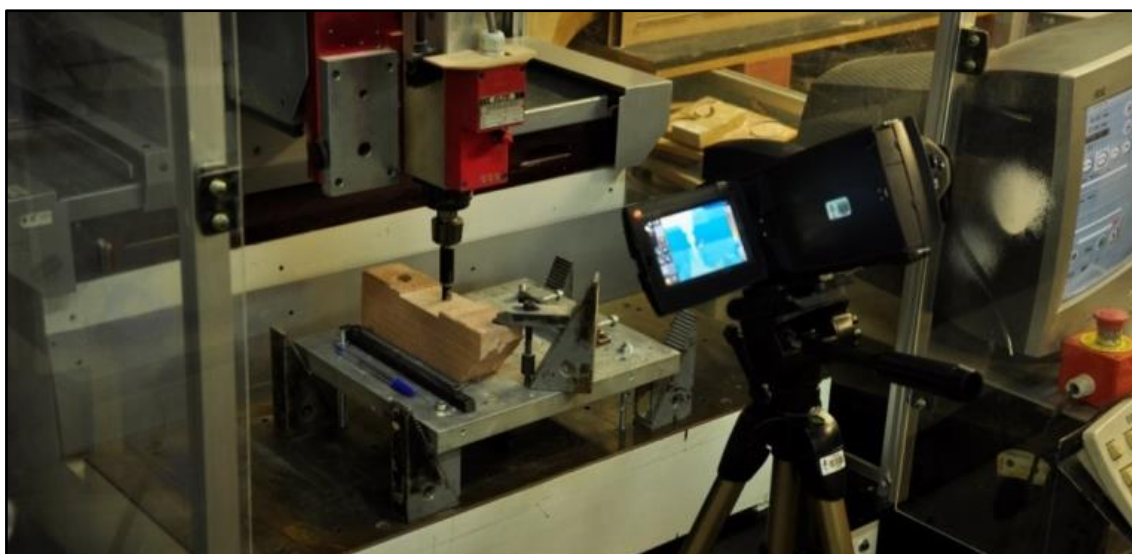
Figura 61 - Medição das temperaturas com termógrafo Testo 890-2
