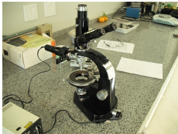
Figura 2. Microscópio com lente objetiva 5,6x e lente ocular de 10x.
