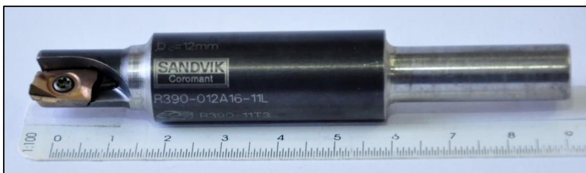
Figura 55 - Fresa Sandvik de 12 mm de diâmetro com inserto intercambiável de PCD
