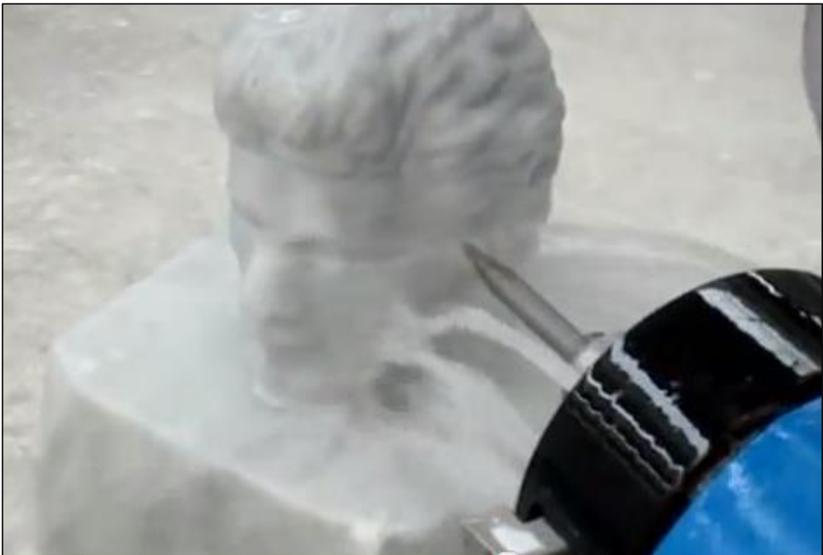
Figura 20 - Centro de Usinagem Breton de cinco eixos em operação de acabamento utilizando fresa
