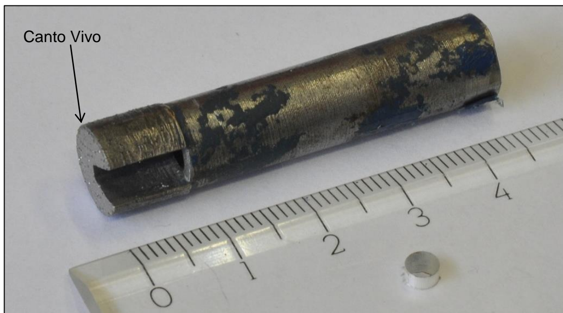
Figura 84 – Broca Diamantada após afiação
