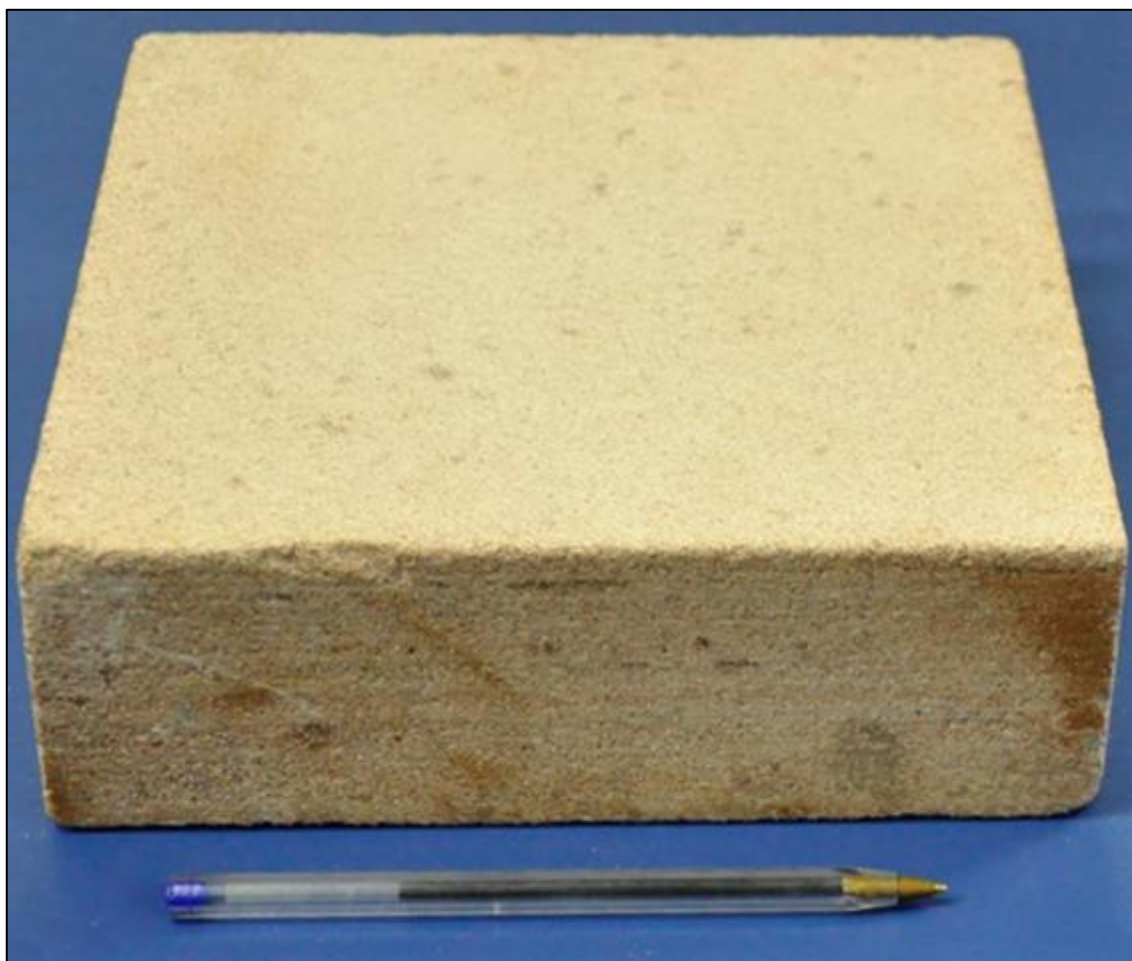
Figura 65 - Bloco de arenito coletado na pedreira e serrado nas dimensões externas
