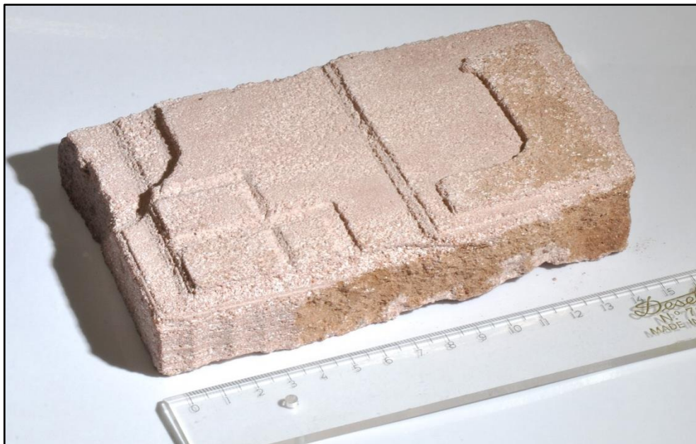
Figura 44 - Resultado dos primeiros ensaios de usinagem do arenito
