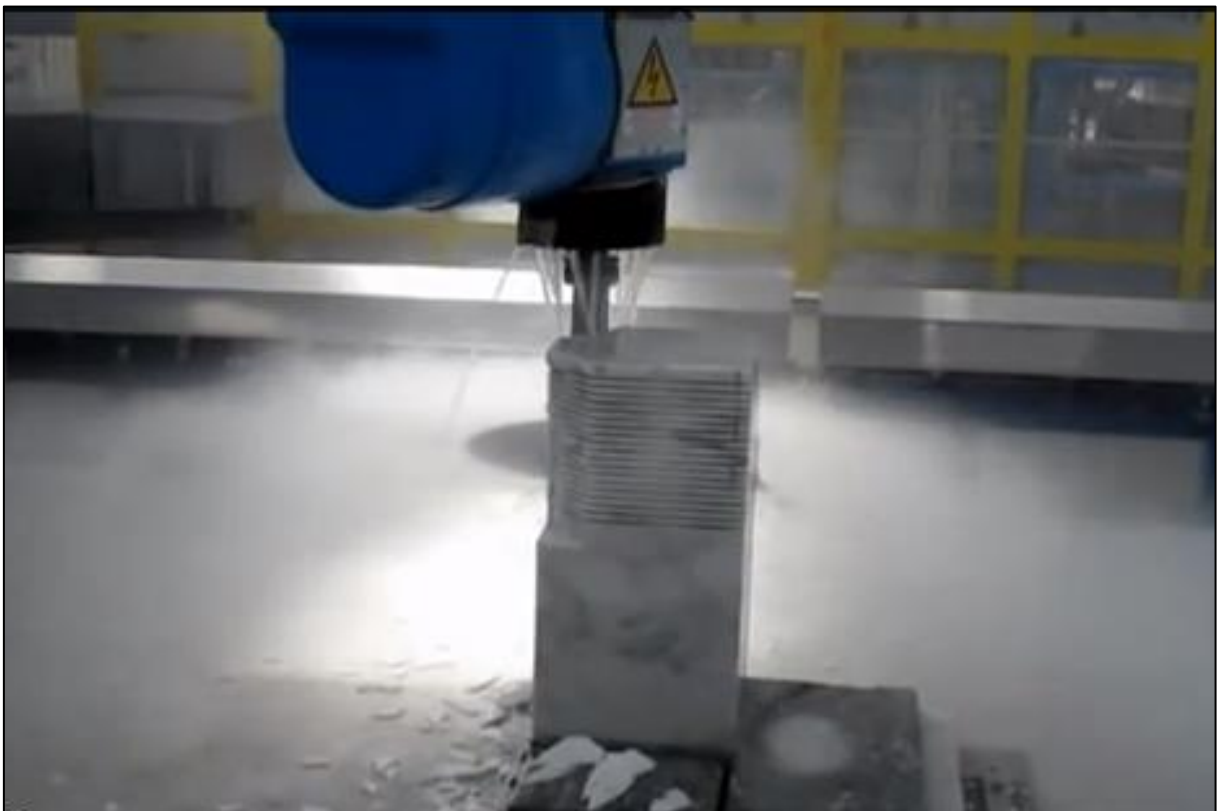
Figura 19 - Centro de Usinagem Breton de 5 eixos em operação de desbaste utilizando serra de disco como ferramenta de corte
