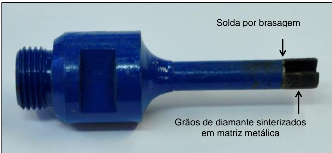
Figura 13 - Broca para furação de mármore e granito de 10 mm de diâmetro de composto de diamante embebido em matriz metálica ligante, utilizada neste trabalho
