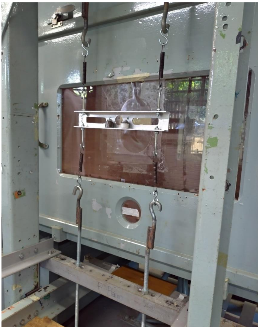
Figura 6.1 - Detalhe do apoio flexível, fixado no pórtico externo à mesa M-I, e posicionamento das molas e das massas agregadas, responsáveis pelo ajuste da relação entre frequências de torção e flexão vertical. Fonte: Acervo do autor.
