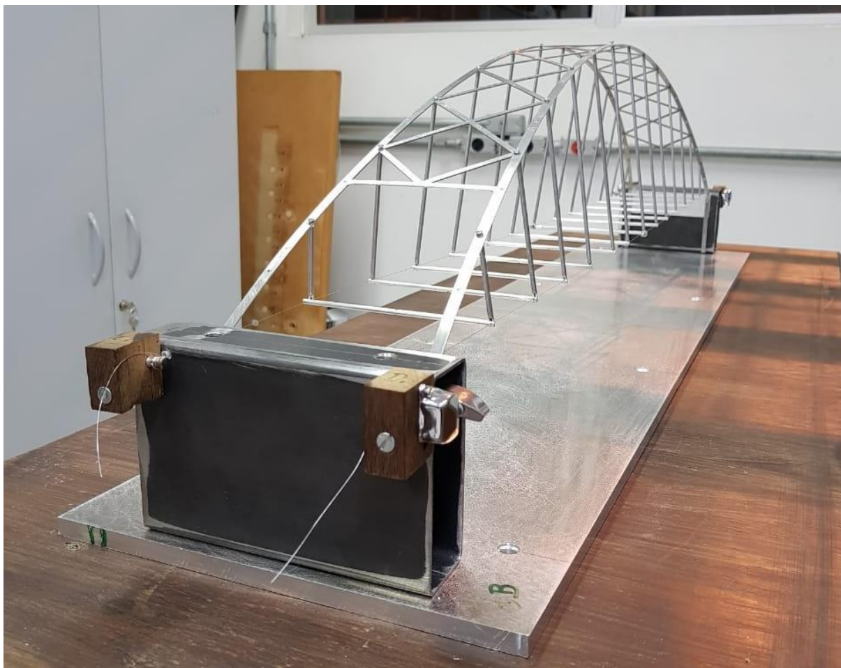
Figura 6.8 - Esqueleto estrutural com o sistema de protensão garantido por tarraxas de guitarra. Fonte: Acervo do autor.
