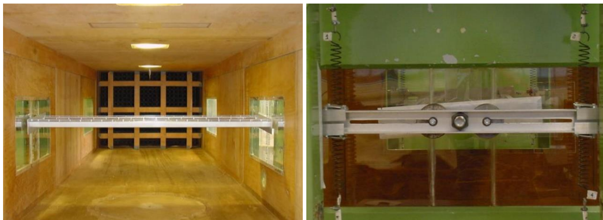
Figura 4.9 - Modelo seccional do Complexo Viário Jornalista Roberto Marinho: vista frontal da seção no túnel de vento, à esquerda, e detalhe dos apoios flexíveis, à direita. Fonte: Loredo-Souza et al. , 2007.
