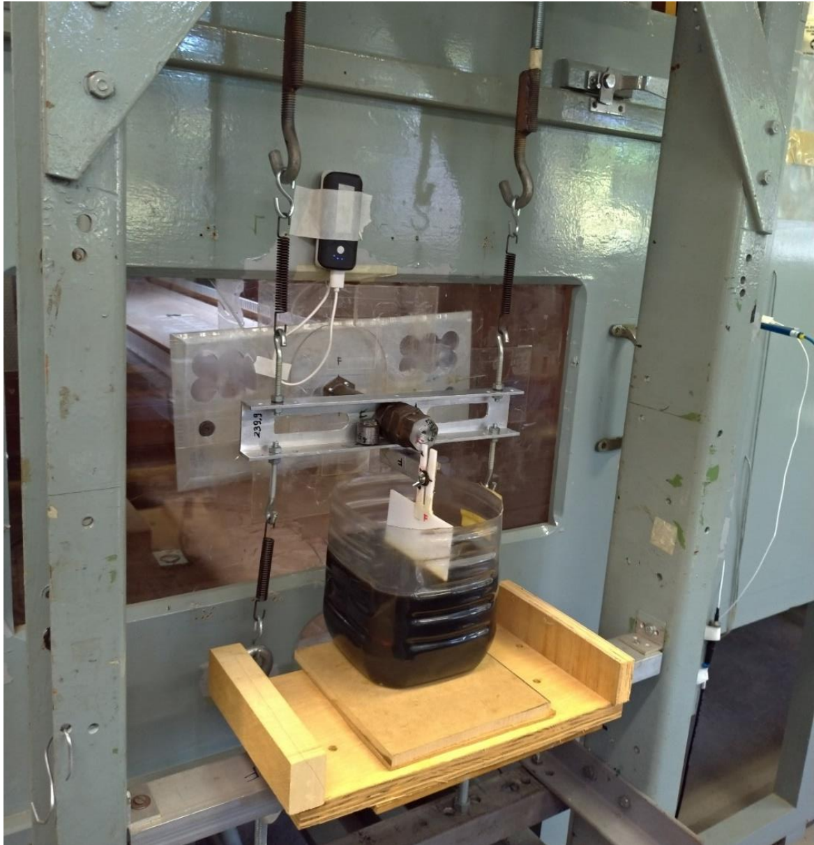
Figura 6.6 - Configuração do apoio flexível para os ensaios dinâmicos do modelo seccional com amortecimento adicional. Fonte: Acervo do autor.
