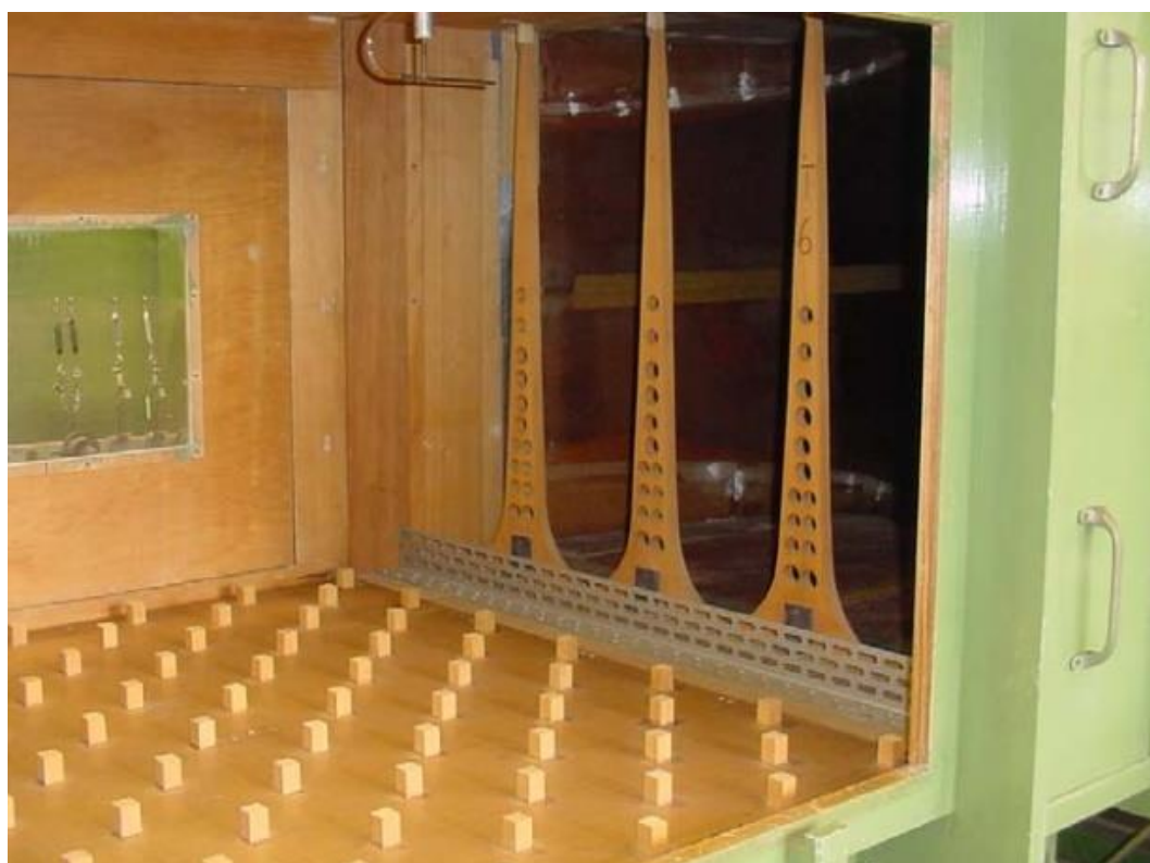
Figura 4.3 - Dispositivos para simulação da camada limite atmosférica: dispositivos utilizados no Túnel de Vento Prof. Joaquim Blessmann. Fonte: Loredo-Souza et al. , 2004.
