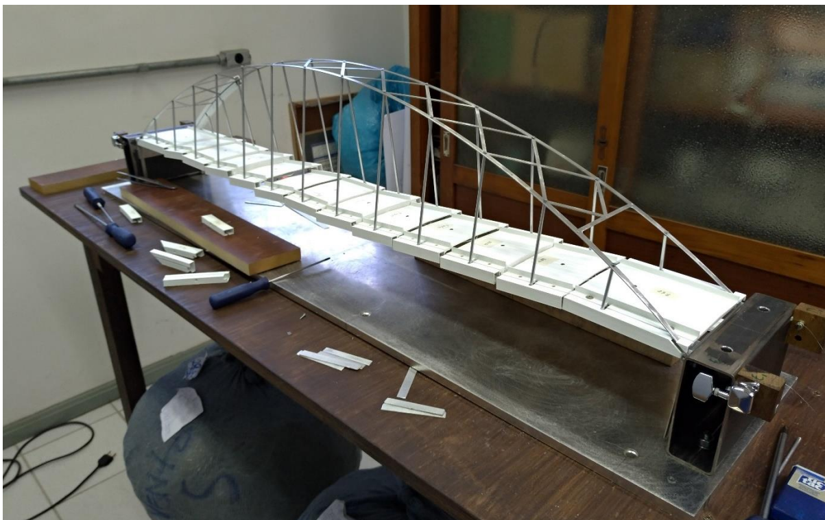
Figura 6.10 - Colocação das carenagens do tabuleiro no modelo aeroelástico completo. Fonte: Acervo do autor.
