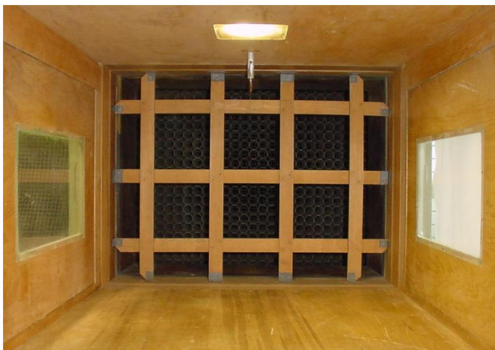
Figura 4.5 - Grelha instalada à barlavento da mesa M-I, para adição de turbulência. Fonte: Núñez, 2008.
