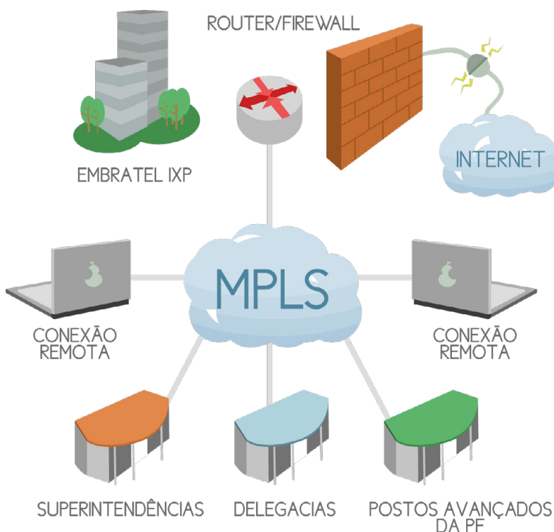
Figura 4 – Esquema Simplificado da Rede MPLS/WAN da PF
