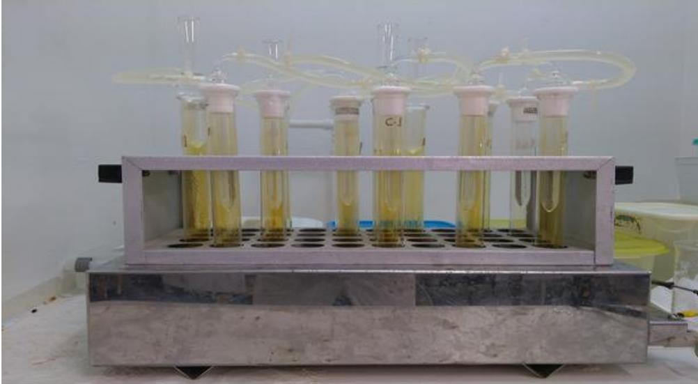
**Figura 2:** Sistema utilizado para a abertura das amostras de lodo e da amostra certificada
