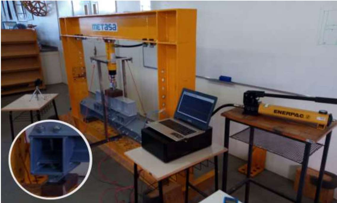
Figura 18 – Configuração original do ensaio – Detalhe do sistema de apoio
