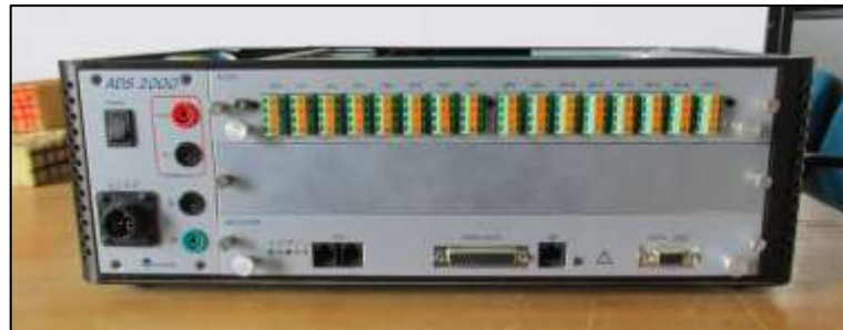
Figura 26 – Gabinete do sistema de aquisição de dados ADS 2000
