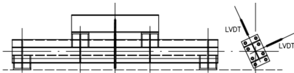
Figura 37 – Posicionamento dos LVDT para Ligações com Chapa de Estendida Sem Enrijecedor
