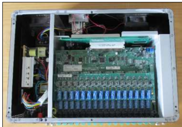
Figura 27 – Interior do gabinete do sistema ADS 2000
