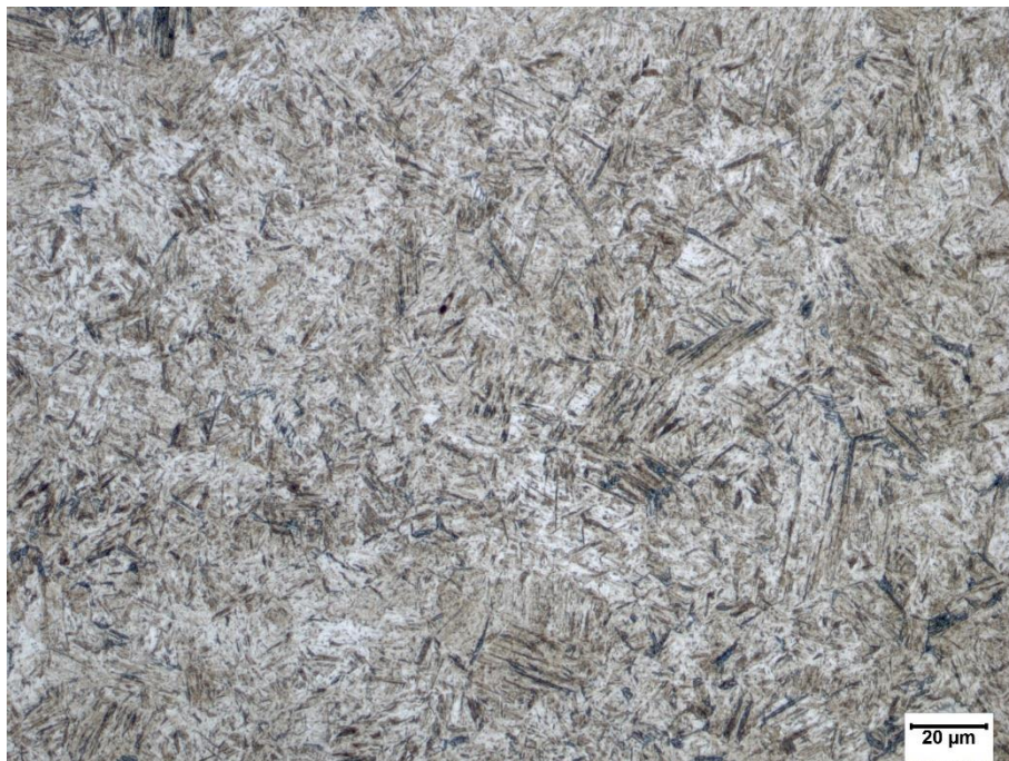
Figura A.2 – Microestrutura dos discos temperados e revenidos a 200 °C, aumento de 500x.
