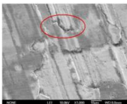
Figura 3.16 – Análise em MEV da superfície com dureza de 65 HRC ensaiada a 0,1 m/s, a elipse indica a delaminação [Adaptado de Tang et al., 2013].
