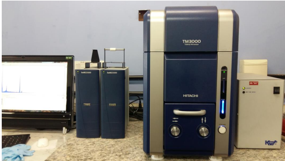
Figura 4.14 – Equipamento utilizado para MEV/EDS marca Hitachi, modelo TM 3000.
