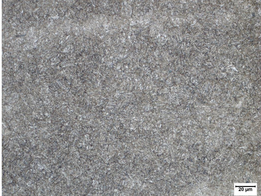
Figura A.5 – Microestrutura dos discos temperados e revenidos a 500 °C, aumento de 500x.
