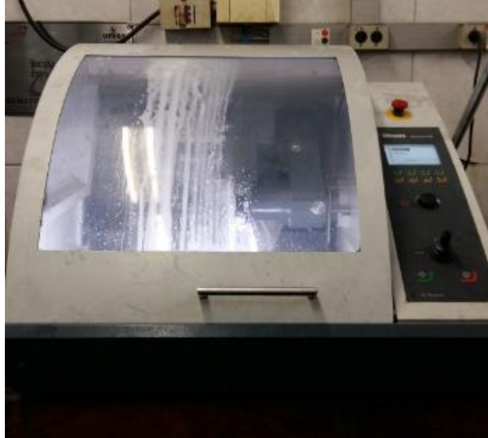
Figura 4.18 – Máquina de corte Struers, modelo Discotom-100, utilizada para cortar os discos.
