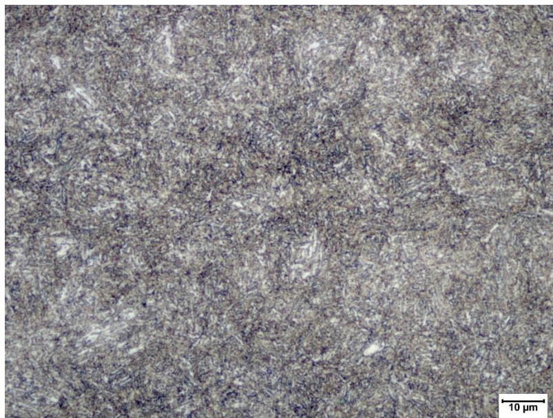
Figura 5.6 – Microestrutura do disco temperado e revenido a 400 °C, aumento de 1000x.
