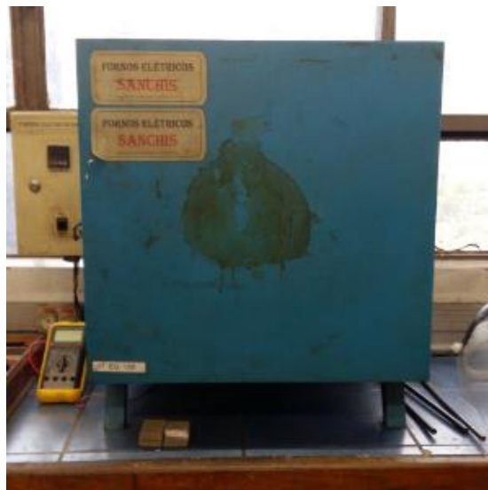
Figura 4.3 – Forno elétrico Sanchis utilizado no revenimento dos discos.
