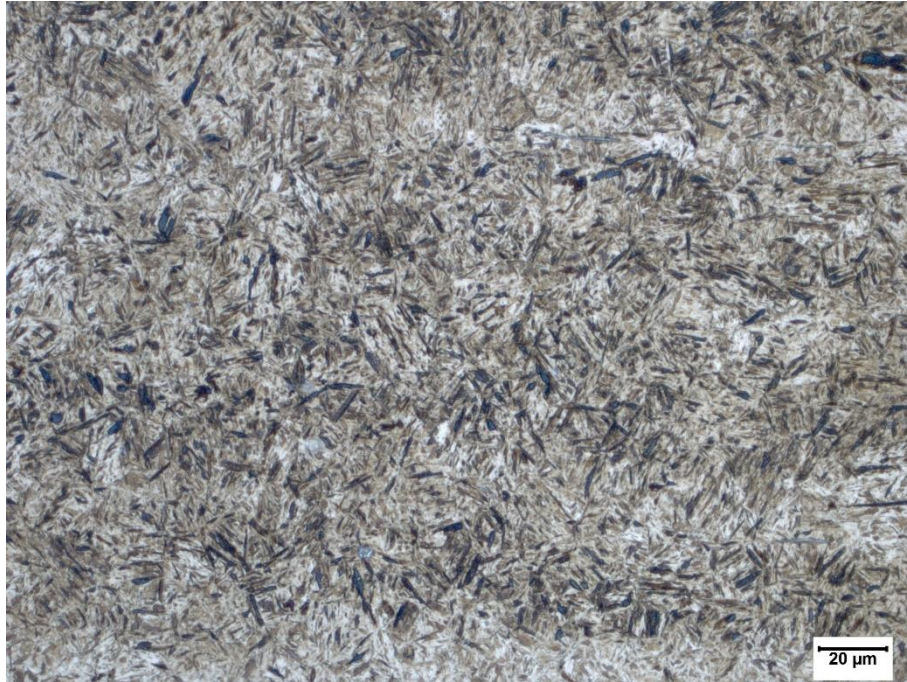
Figura A.1 – Microestrutura dos discos temperados, aumento de 500x.
