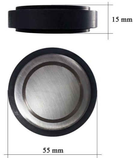
Figura 4.2 – Dimensões dos discos.
