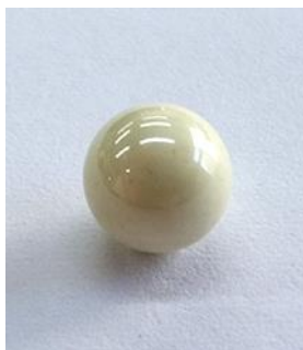
Figura 4.4 – Esfera de zircônia utilizada nos ensaios.
