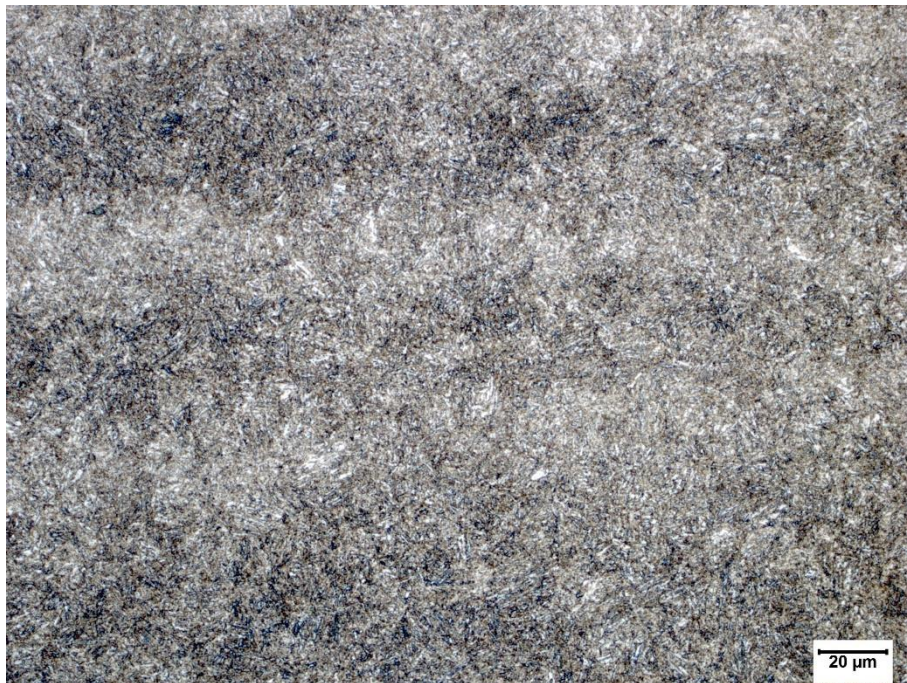
Figura A.4 – Microestrutura dos discos temperados e revenidos a 400 °C, aumento de 500x.
