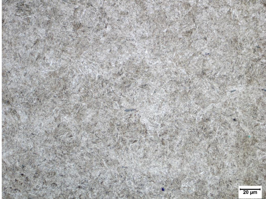
Figura A.3 – Microestrutura dos discos temperados e revenidos a 300 °C, aumento de 500x.
