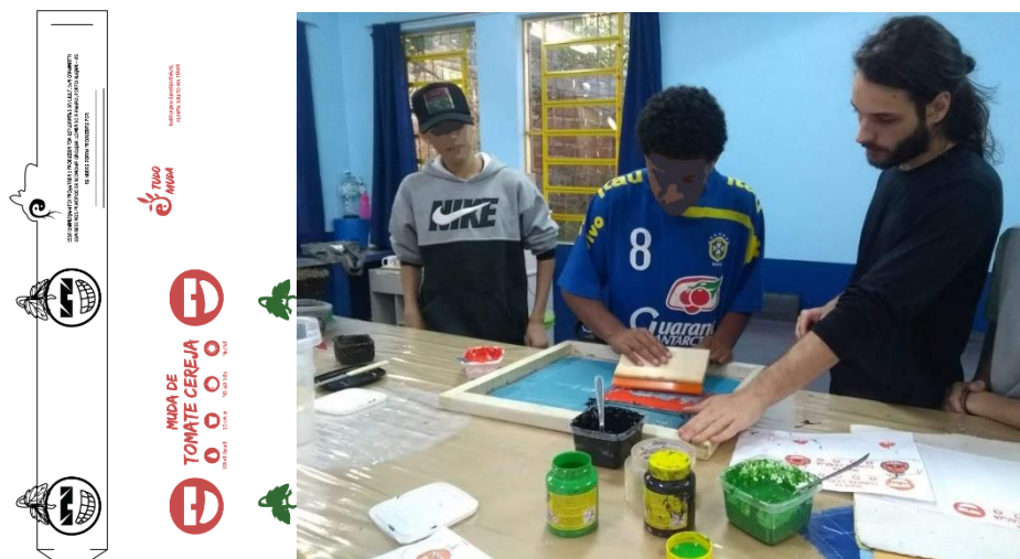
Figura 53 - Separação de cores para as telas e tintas sendo testadas em serigrafia
