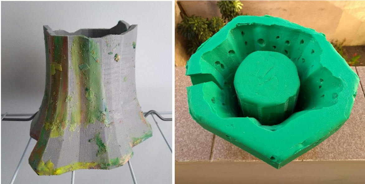
Figura 44 - Modelo impresso e molde de silicone confeccionado a partir do modelo
