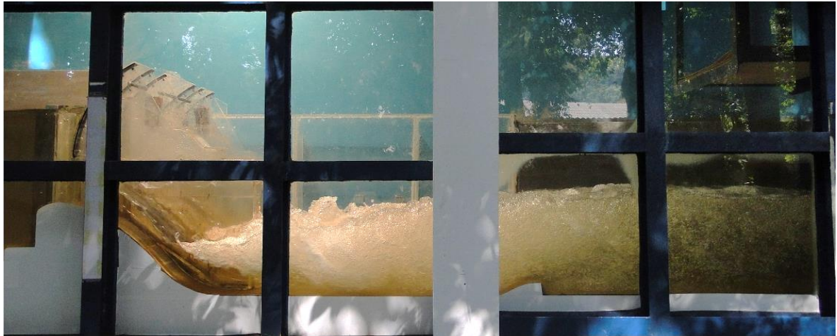
Figura 31: Modelo bidimensional da UHE São Manoel, em escala 1:60, ensaio com vazão 182,3 l/s.
