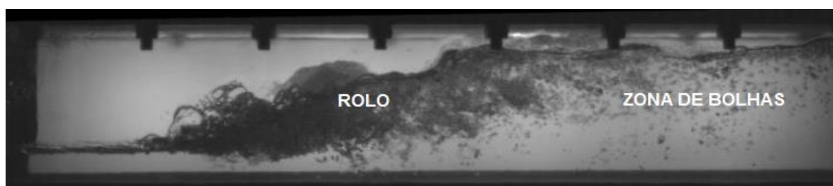
Figura 4: Ressonância Hidráulica formado a jusante de vertedouro de calha lisa (Fonte: CHIEW, EMADZADEH, 2017).
