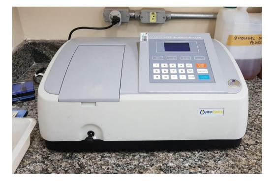
Figura 31: Espectrofotômetro UV-1600
