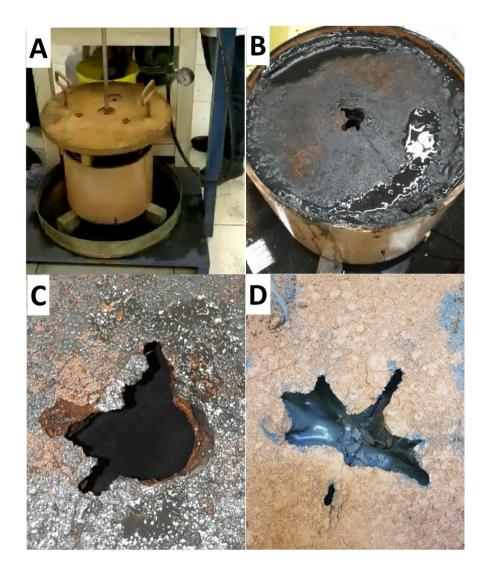
Como pode ser observado da Figura 74 A, visando simular condições reais de campo, acoplou-se à superfície do corpo de prova um sistema de carga que simulasse a pressão exercida por cerca de 50 cm de solo natural. Este procedimento foi adotado em virtude de que a tecnologia de injeção sob pressão não é aplicada na superfície do solo, mas sim, em áreas subsuperficiais.
