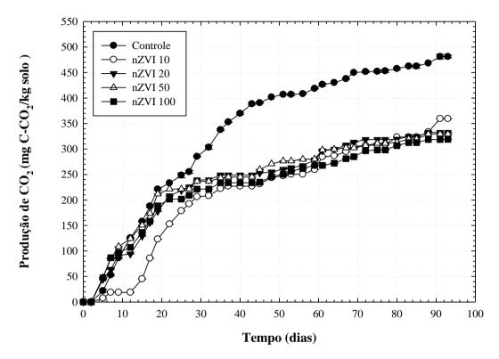
Figura 49: Produção de CO<sub>2</sub> em contaminação com nZVI
