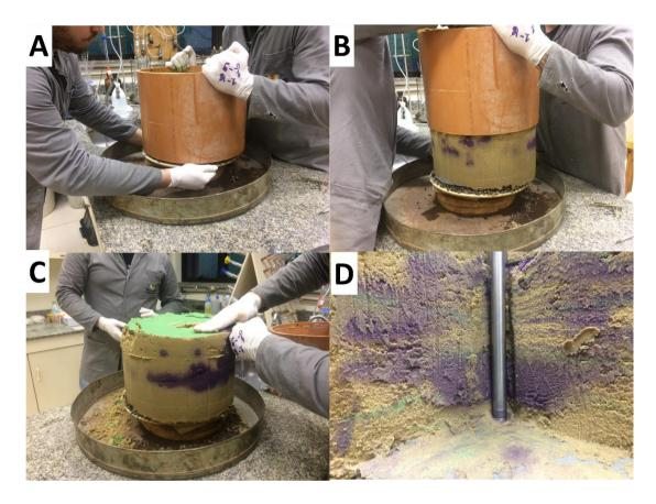
Como pode ser observado na Figura 73 B, devido ao solo utilizado para o teste piloto ser de origem arenosa, o processo de exumação foi realizado sem complicações, fazendo com que o tubo do reator fosse retirado completamente.
