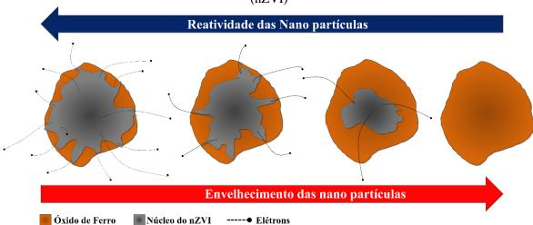
Figura 19: Efeitos do envelhecimento na reatividade das nano partículas de ferro zero valente (nZVI)
