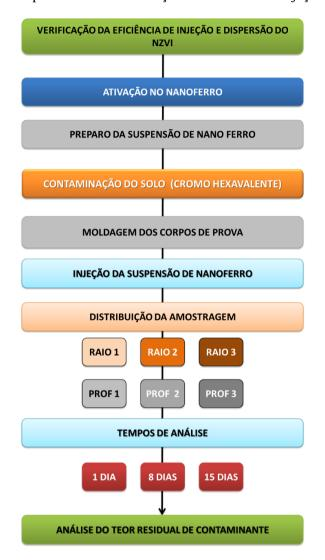
Figura 37: Fluxograma experimental da verificação da eficiência de injeção e dispersão no nZVI
