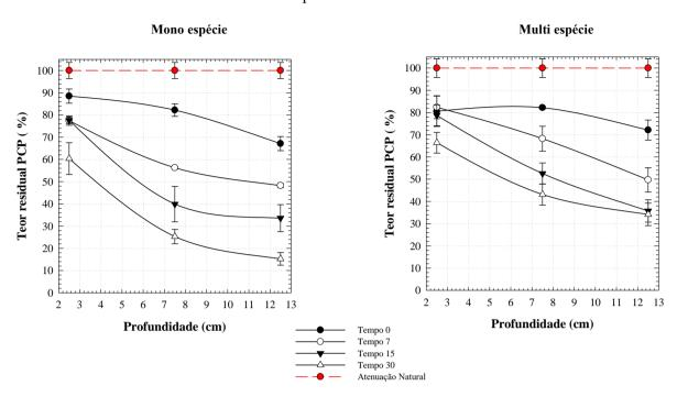
Figura 80: Variação de degradação de Pentaclorofenol em mono e multi-espécie em função da profundidade
