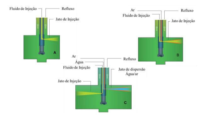
Figura 21: Sistemas Injeção sob pressão: a) Monofuído, b) Bifluído e c) Trifluído
