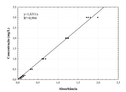
Figura 35: Compilado de curvas de calibração (Cr<sup>6+</sup>) utilizadas no experimento
