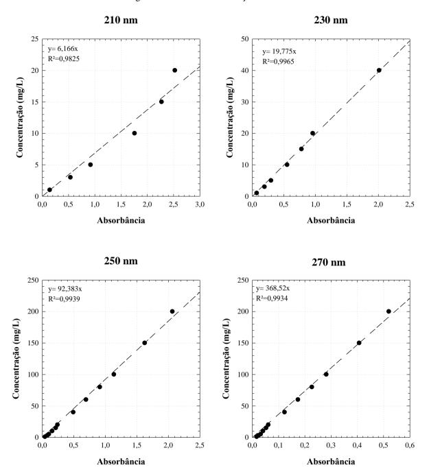
Figura 46: Curvas de calibração linearizadas
