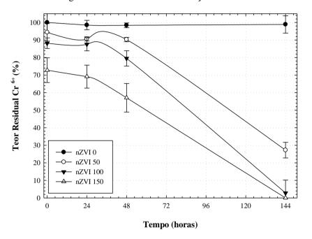
Figura 58: Decaimento concentração de Cromo Hexavalente
