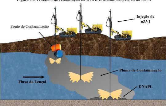
Figura 11: Processo de remediação de DNAPL usando suspensão de nZVI
