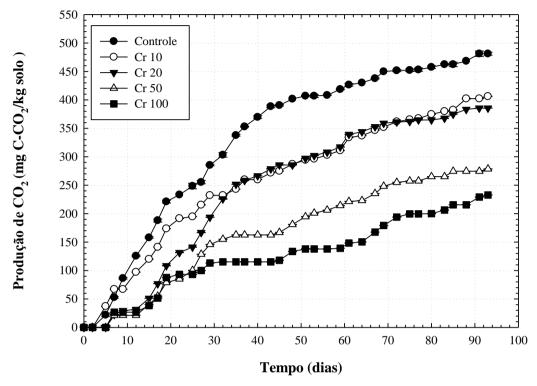
Figura 51: Produção de CO<sub>2</sub> em contaminação com Cromo Hexavalente
