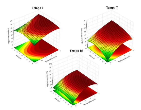
Figura 79: Modelo de superfície de resposta para a verificação do sistema de injeção de nZVI
