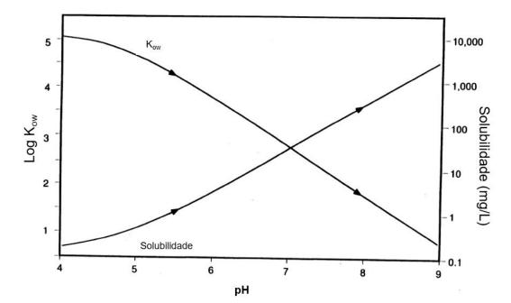
Figura 4: Partição do Pentaclorofenol em função do pH
