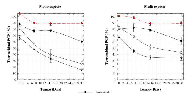
Figura 81: Variação de degradação de Pentaclorofenol em mono e multi-espécie em função do tempo
