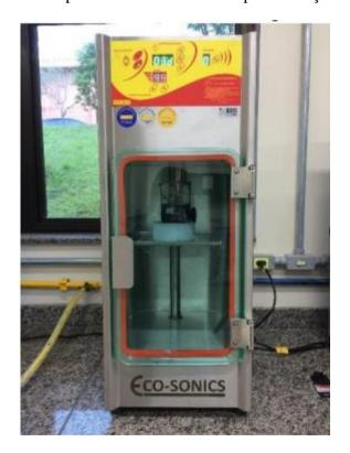
Figura 28: Disruptor de Células utilizado para ativação do nZVI
