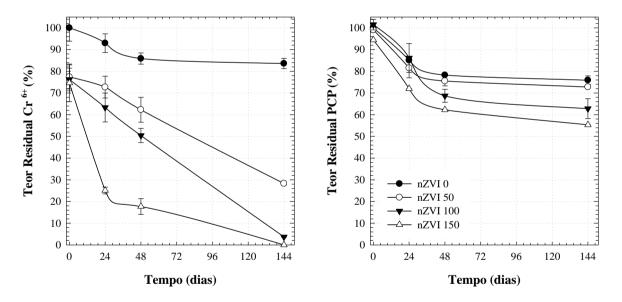
Figura 62: Decaimento concentração do Cromo Hexavalente e Pentaclorofenol
