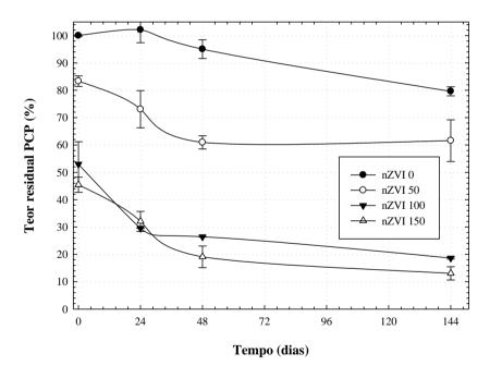
Figura 60: Decaimento concentração de Pentaclorofenol
