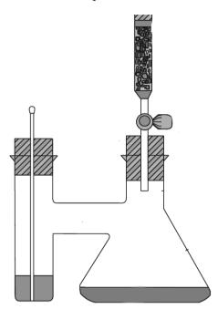
Figura 34: Modelo esquemático do Frasco de Bartha
