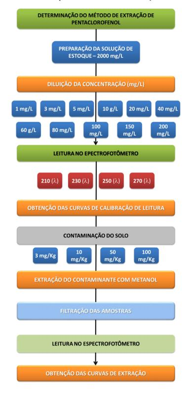
Figura 29: Delineamento experimental do método de Extração do Pentaclorofenol
