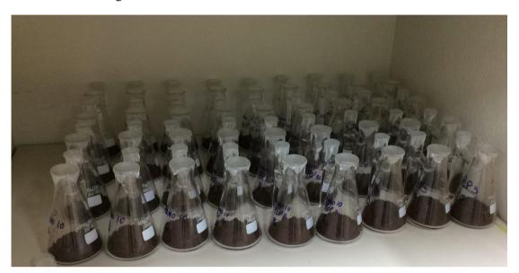
Figura 33: Reatores do ensaio de toxicidade dos elementos
