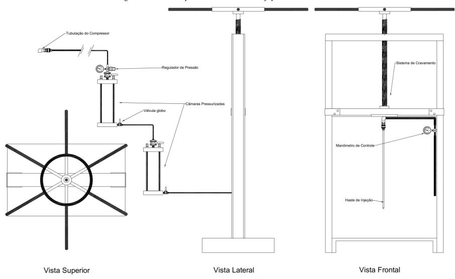
Figura 41: Modelo Esquemático do Sistema de Injeção de nano ferro
