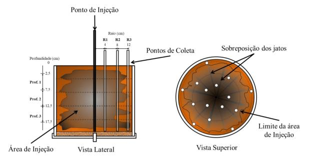
Figura 42: Vista do reator de injeção
