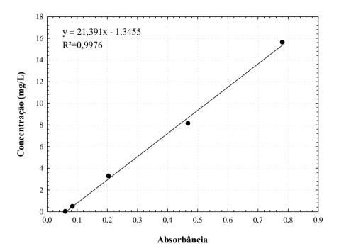
Figura 48: Curva de extração do Pentaclorofenol do solo
