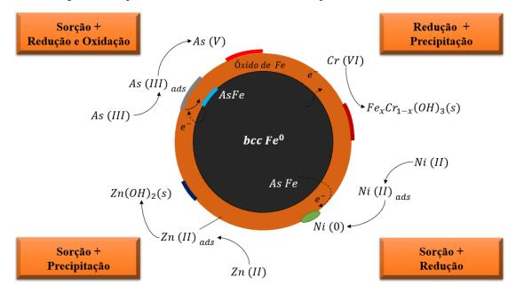
Figura 15: Papel da estrutura núcleo-concha no sequestro de contaminante
