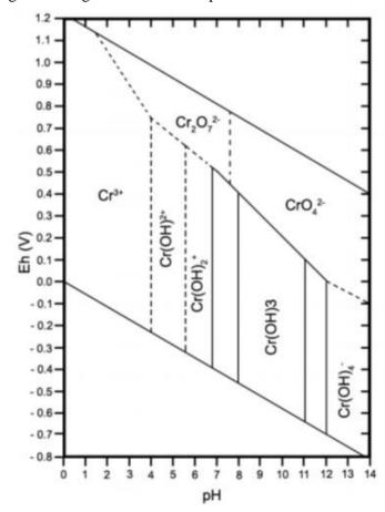
Figura 9: Diagrama de Pourbaix para o elemento Cromo
