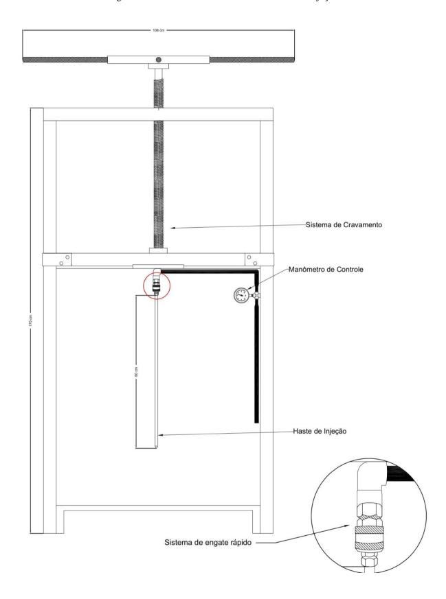
Figura 40: Vista Frontal Detalhada do sistema de Injeção
