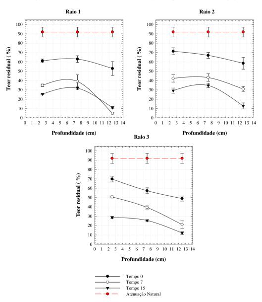
Figura 76: Variação o teor residual em função da profundidade de injeção
