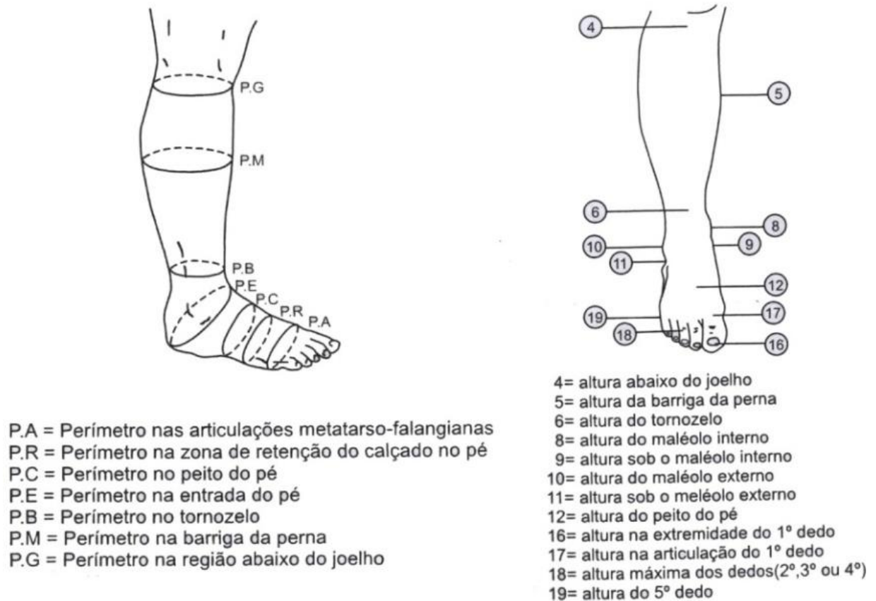
Figura 8. Medidas de perímetro e altura dos pés.
