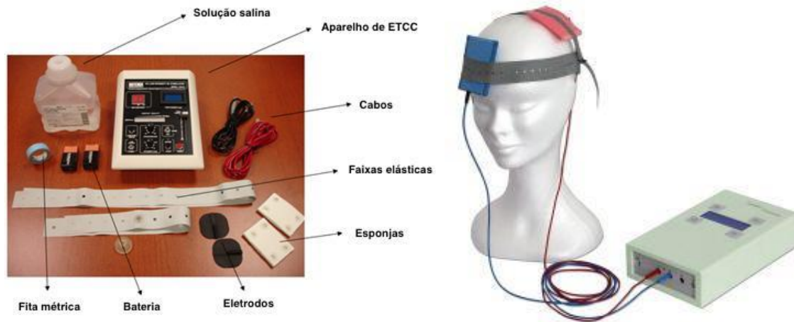
Figura 6. Exemplo de aparelho de estimulação transcraniana por corrente contínua utilizado em estudos clínicos. Figura adaptada de DaSilva, Volz [149] e https://hearingthevoice.org/2016/05/20/transcranial-direct-current-stimulation-over-hyped-or-under-studied-by-peter-moseley/ (acesso dia 24/09/2018).
