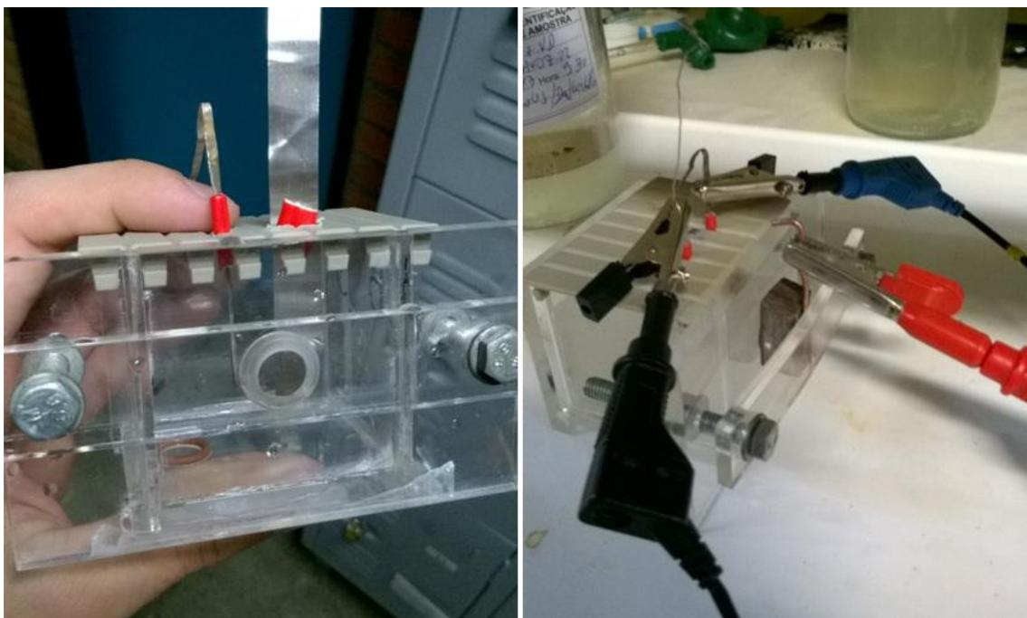
**Figura 19 - Célula de ensaio com tampa e em ensaio**
