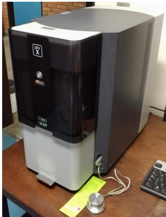
**Figura 22 - Microscópio eletrônico de varredura utilizado**
