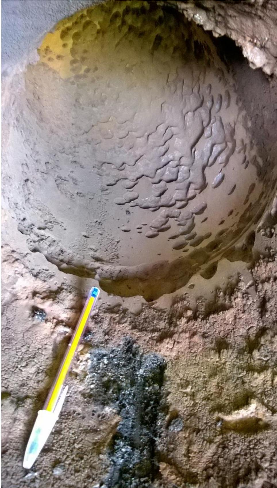
**Figura 24 - Trecho de tubulação de 16" que furou em operação**
