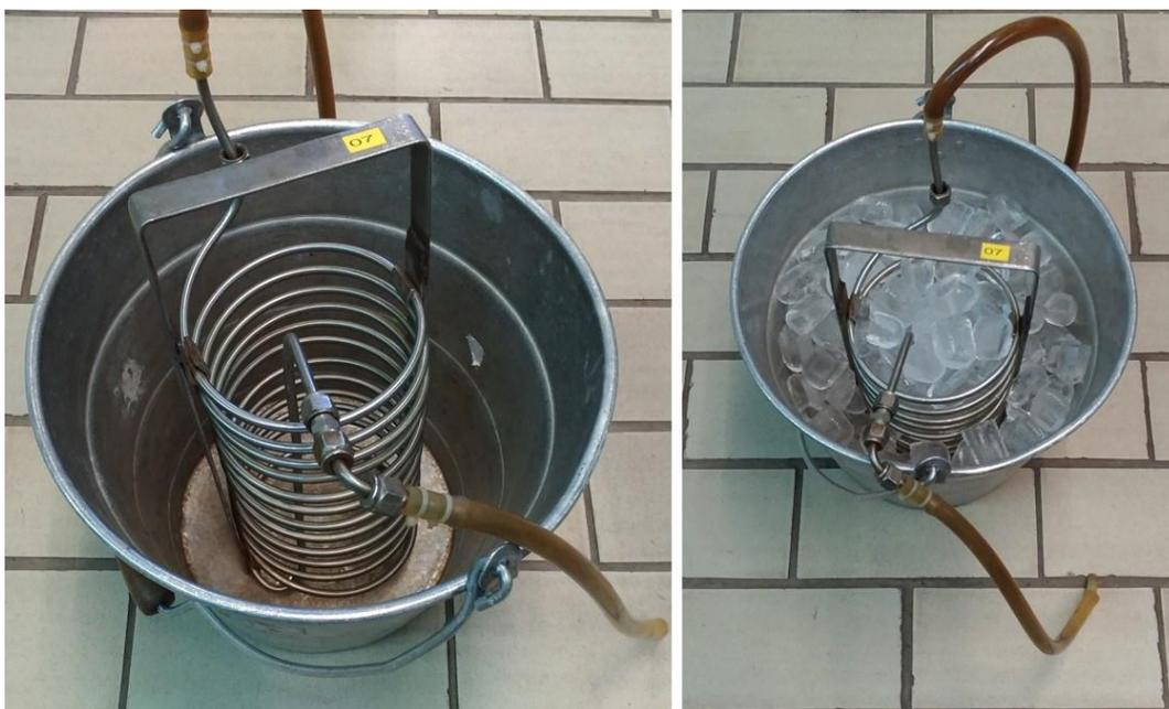
**Figura 15 - Sistema de condensação e coleta, onde gelo é responsável pela refrigeração**
