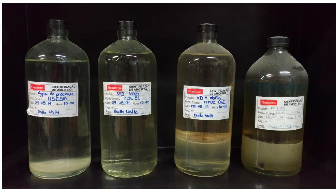
Da esquerda para a direita: (1) Condensado de VD imediatamente antes do DSH, (2) condensado de VD retirado no topo da torre de produção, (3) e (4) condensado da mistura VD e nafta, com fase aquosa no fundo.
