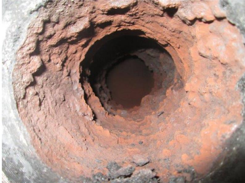
**Figura 28 - Curva após válvula de controle sem depósito e com erosão**
