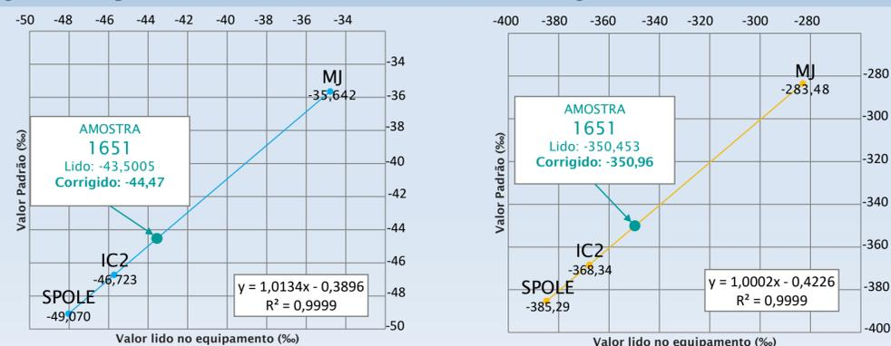
Figura 2. Gráficos com as curvas de calibração utilizadas na linearização da amostra 1651 (ponto verde). A curva da esquerda foi aplicada na correção do valor de  $\delta^{18}\text{O}$ , e a da direita na correção do  $\delta\text{D}$ .
