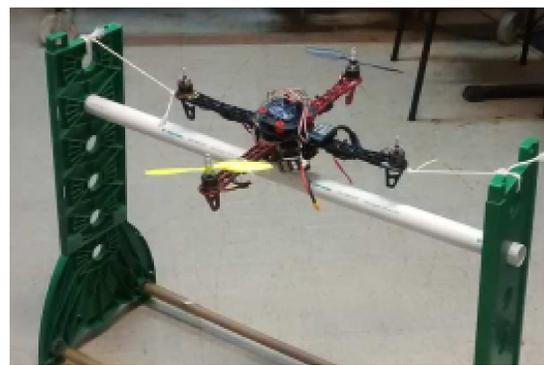
Figura 5: Quadróptero disponível no Laboratório de Sistemas de Controle, Automação e Robótica (LASCAR) com a estrutura associada para testes
