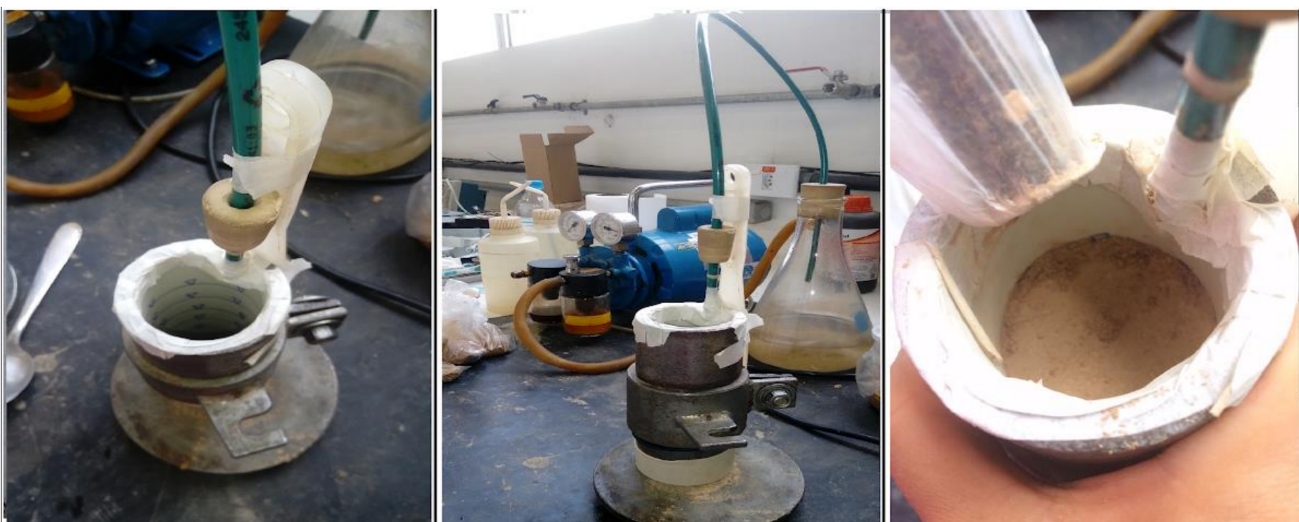
Preparação do corpo de prova para ensaio triaxial
