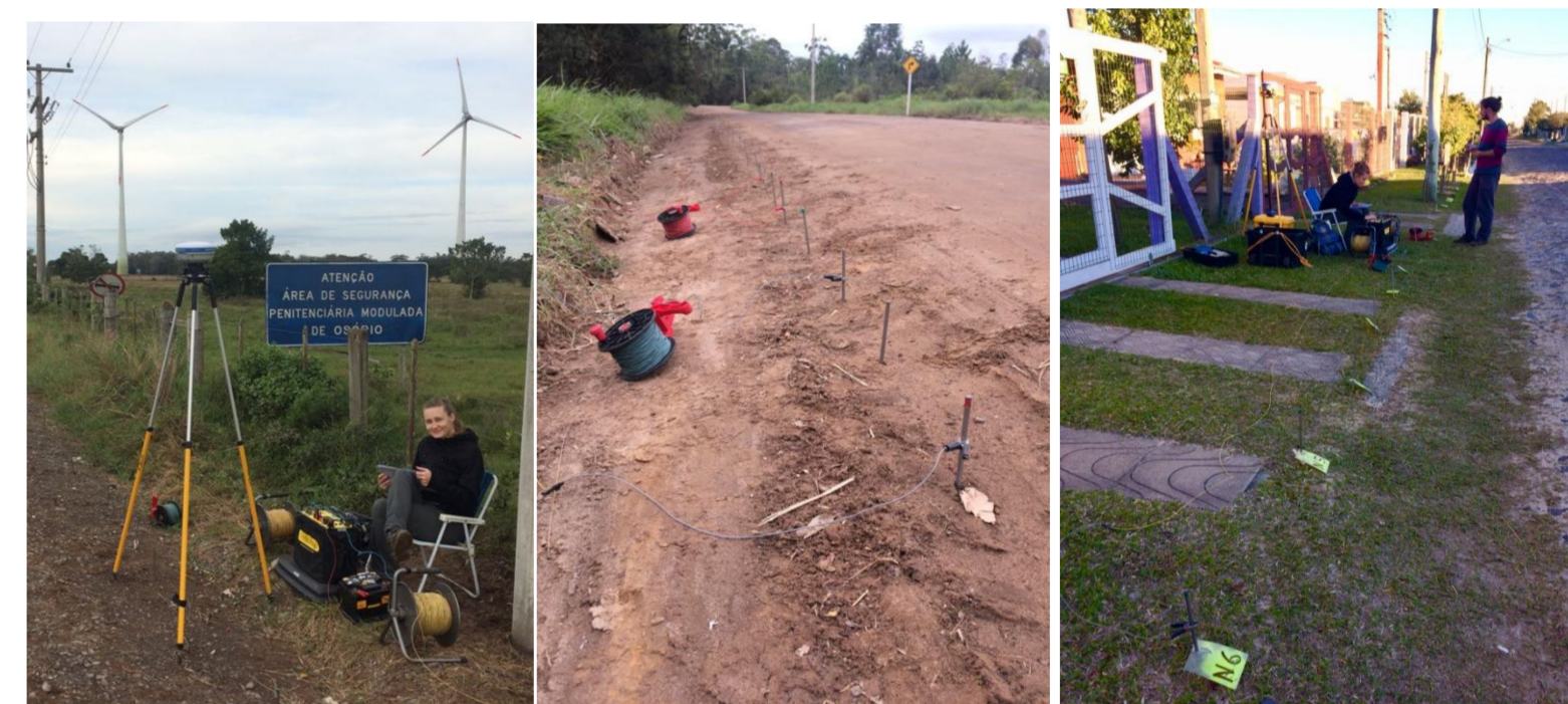
Levantamentos geoeletricos foram realizados por equipe de três pessoas: uma operando eletrorresistivímetro, enquanto as outras duas realizavam a mudança no arranjo dos eletrodos.
