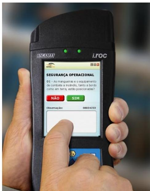
**Figura 03 – Computador Classificado com Leitor RFID**
