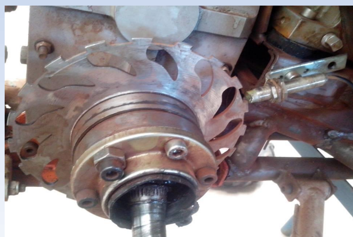
Disco de freio com ranhuras e sensor indutivo
