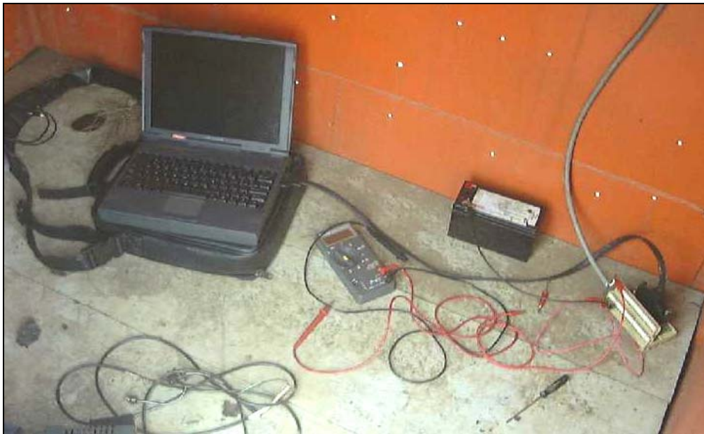
Figura 48. Sistema de aquisição e gravação de medição de velocidade de detonação VAR.
