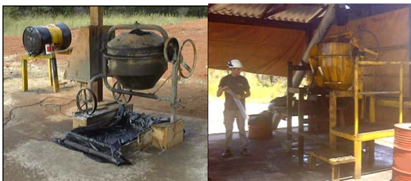
Figura 31. Planta piloto de mistura (esquerda) e atual instalação (direita) para mistura de ANFO e ANWO.
