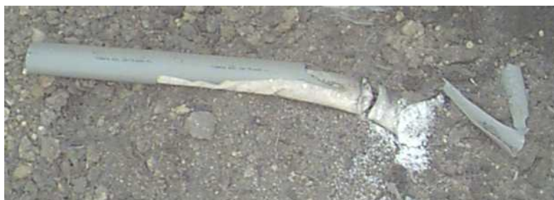
Figura 46. Cartucho intacto de ANFO em teste com confinamento “baixo” em tubo de PVC.
