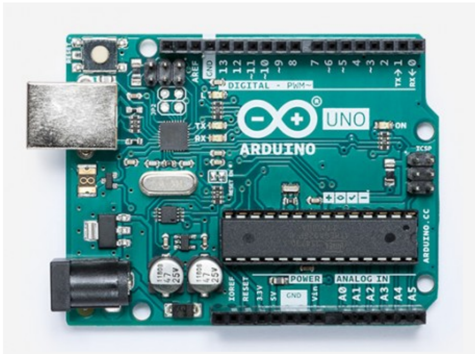
Figura 12 - Placa controladora do ARDUINO UNO, utilizada para o sistema de comando, monitoramento e aquisição de dados da máquina BTD.
