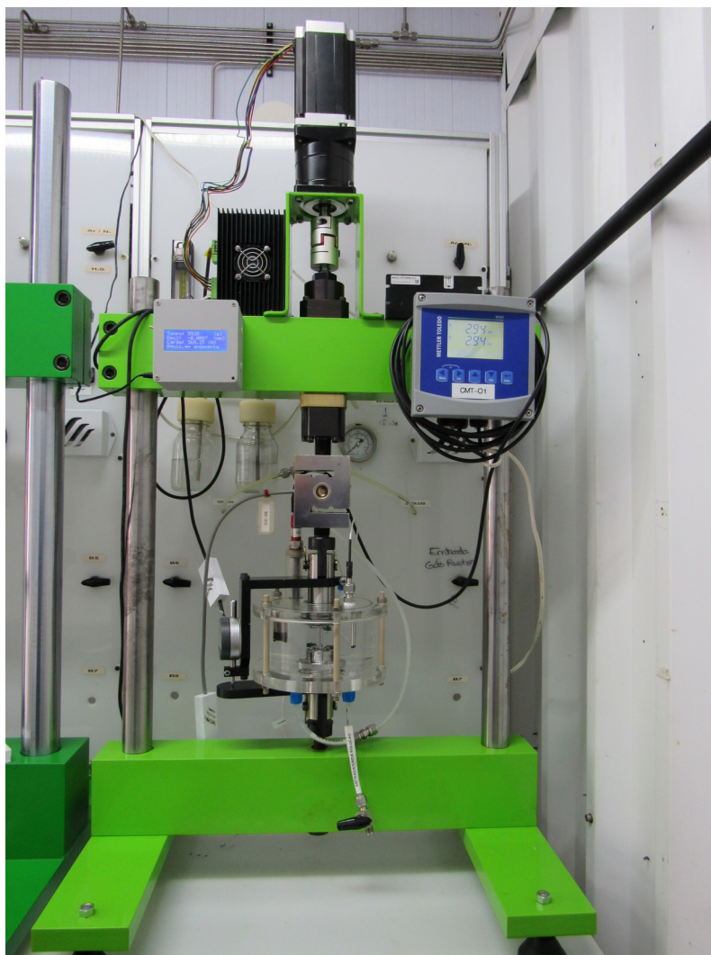
Figura 16- Imagem da máquina de tração de ensaios BTM com a célula de teste.
