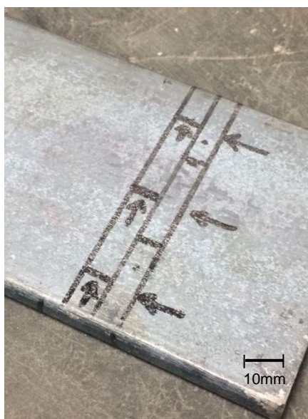
Figura 23 – Detalhe dos pontos de corte de amostras apresentadas na Figura 22 para análise transversal e longitudinal.
