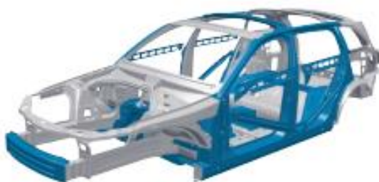
Figura 21– Aplicações de aço ao manganês e ao boro, na estrutura de um automóvel. Fonte: https://www.thyssenkrupp-steel.com/de/produkte/feinblech-oberflaechenveredelte-produkte/mangan-bor-stahl-zum-warmumformen/mbw-mangan-bor-stahl-zum-warmumformen/ .
