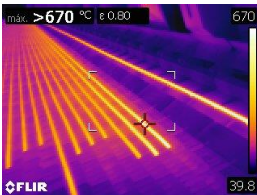
Figura 27 – Análise termográfica das barras no leito de resfriamento, antes de mudanças nos parâmetros de laminação.
