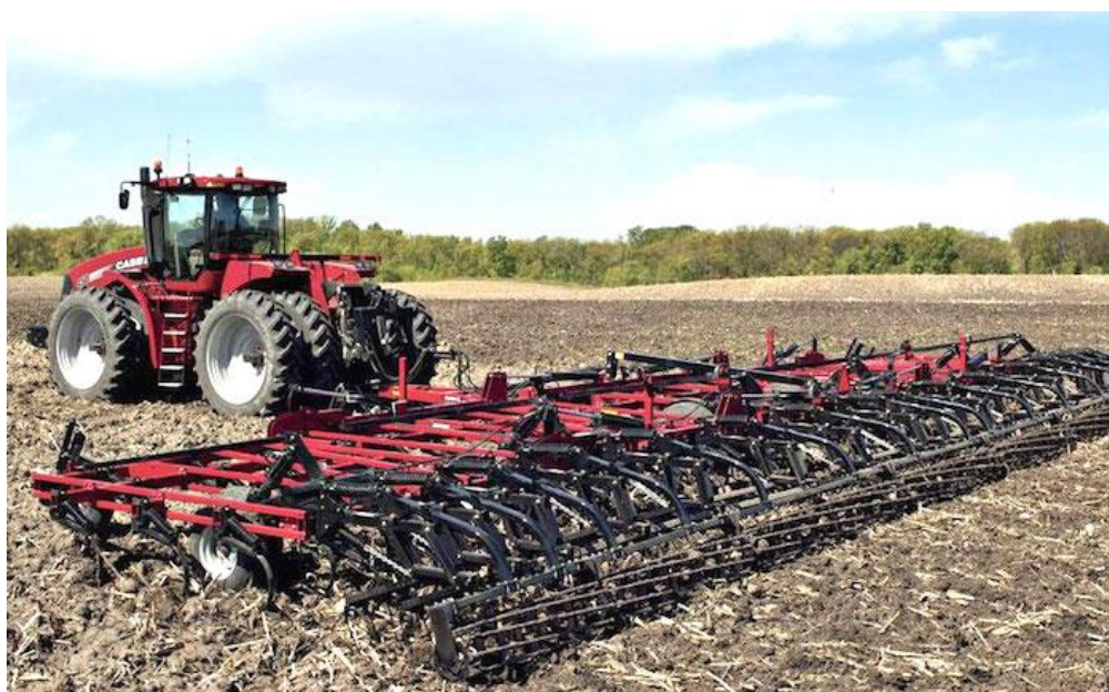
Figura 17 – Implemento de varredura, para preparação do solo. Fonte: http://farmandlivestockdirectory.com/get-longer-wear-from-your-wheel-track-sweeps/
