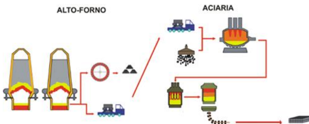
Figura 10 – Esquema do processo de produção dos tarugos. Fonte: Modificado de https://ianalitica.wordpress.com/aplicacoes-com-analisadores-industriais/cems-em-siderurgia/ .
