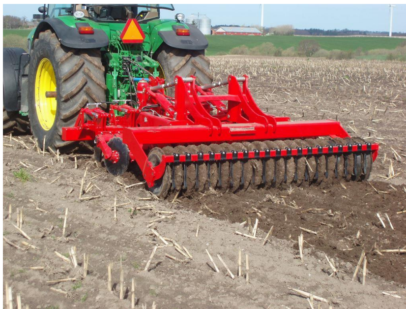
Figura 16 – Arado em funcionamento, aplicado à máquina agrícola. Fonte: http://www.he-va.co.uk/he-va-products/cultivation/combi-disc/
