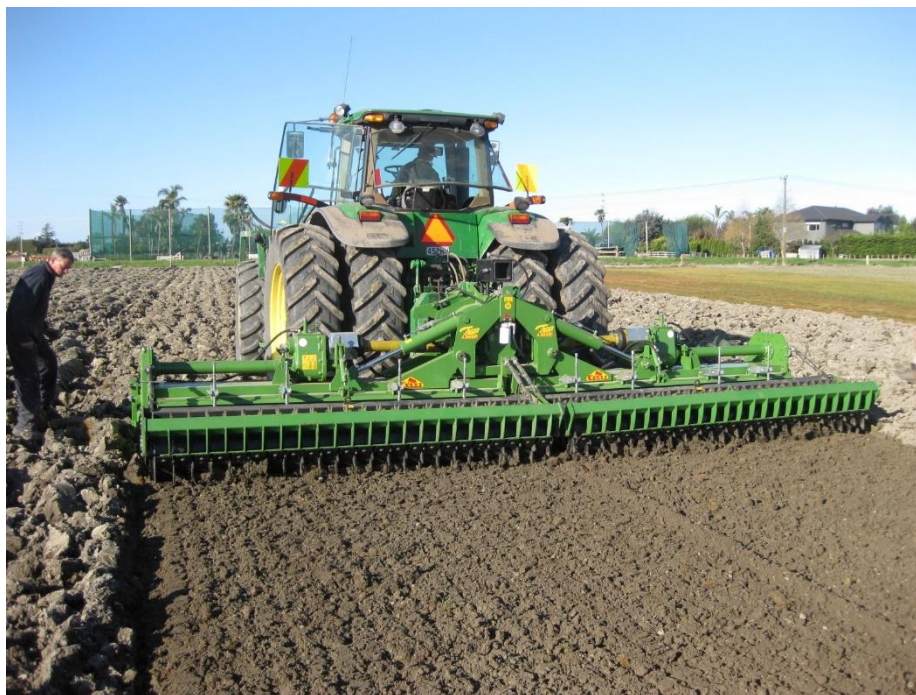
Figura 18 – Rotores de pico, aplicados para aerar o solo.
