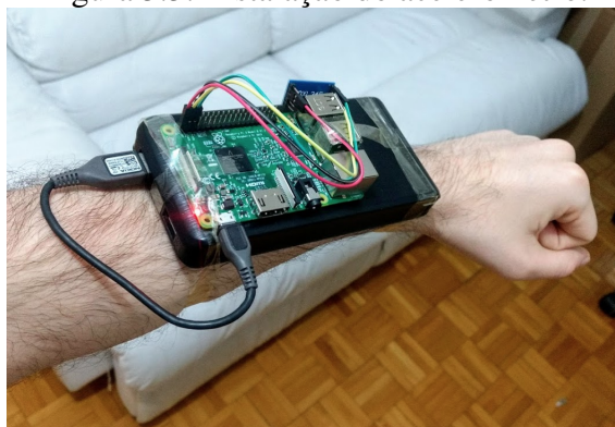
Figura 5.3: Instalação do acelerometro.
