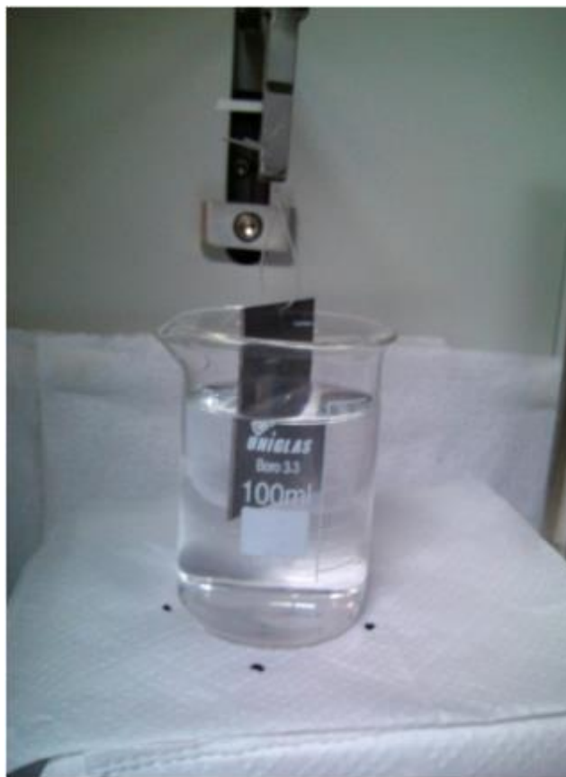
Figura 11 - Processo de imersão por dip-coating na solução de ácido esteárico.
