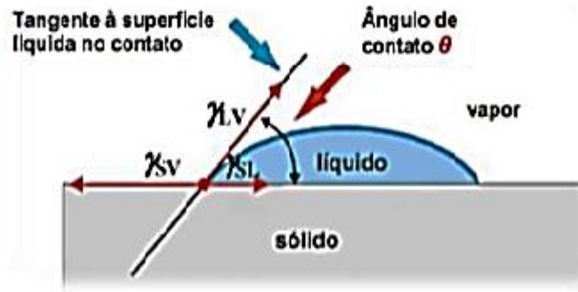
Figura 5 - Ângulo de contato ( \theta ) formado entre a superfície sólida e a tangente da superfície líquida [25].
