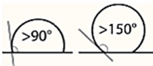
Figura 1 - Ilustração esquemática da superfície hidrofóbica e superhidrofóbica com ângulos maiores que 90^\circ e 150^\circ , respectivamente [1].
