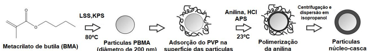
Figura 14. Processo de síntese das partículas núcleo-casca de polimetacrilato de butila/PAni utilizado por Han et al. (2007).
