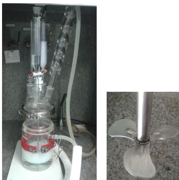
Figura 22. Reator e haste de agitação utilizados na obtenção das emulsões acrílicas via polimerização em emulsão.
