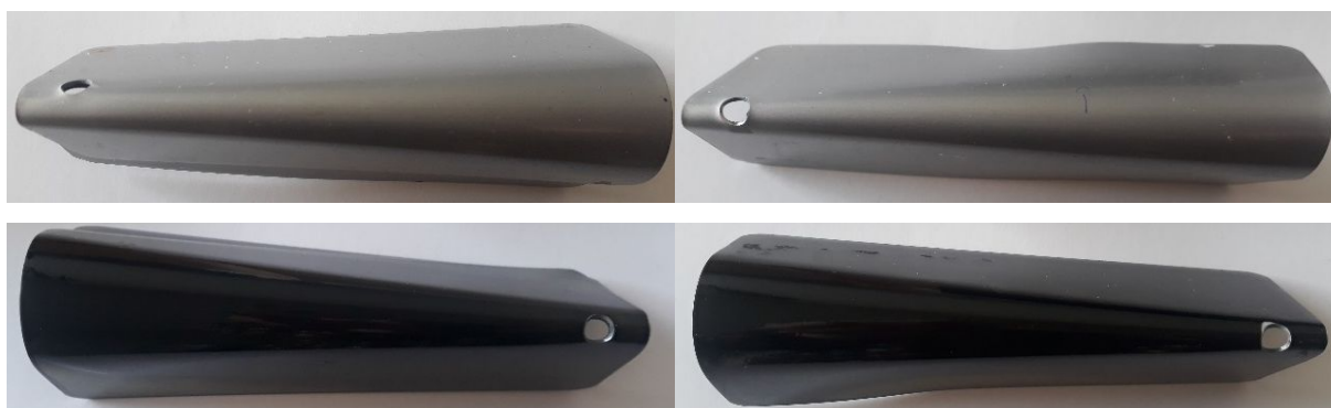
Figura 54. Resultado da análise de flexibilidade por mandril cônico realizado nos painéis de aço carbono revestimentos com o látex P(MMA/BA) e P(MMA/BA)/PAni.
