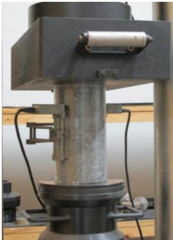
Figura 5 – Fonte de erro de leitura de deformação (Katayama, 2016)
