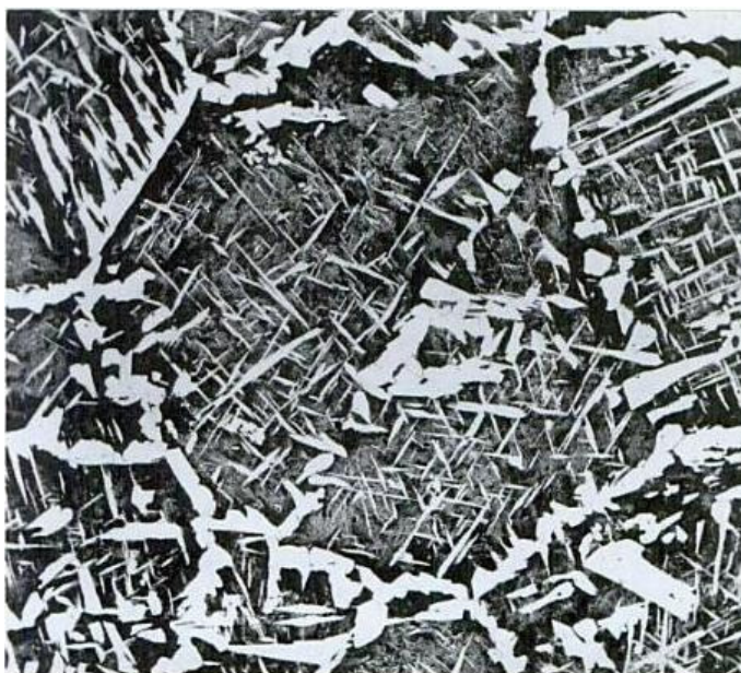
Figura 2.17 Aço hipoeutetóide austenitizado por 1h a 1350°C e resfriado a uma taxa de 300°C/h. Tamanho de grão austenítico N° 0. Ataque: Picral. Aumento 100X (SAMUELS 1999).
