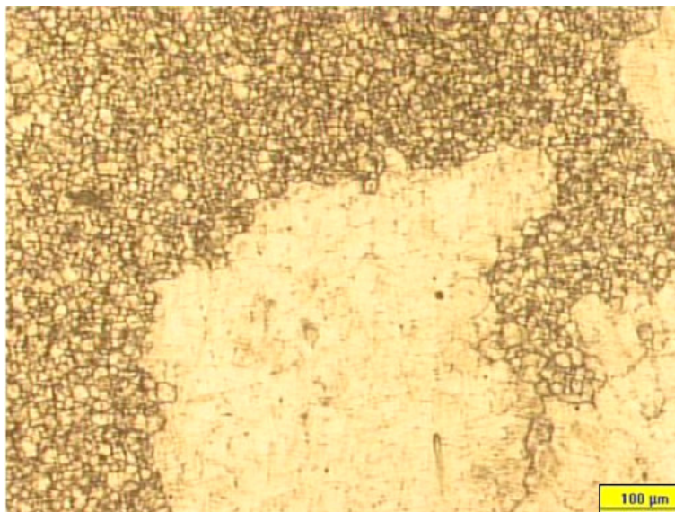
Figura 4.17 Tamanho de grão no núcleo de uma peça da amostra A, aço sem adição de Nióbio utilizando processo I. Observado crescimento anormal de grão. Os grãos mais finos têm tamanho ASTM 8,0, os grãos grosseiros observados ASTM 2,0 - Ataque Ácido Pícrico + Teepol.
