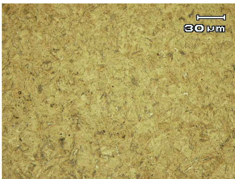
Figura 4.9 Núcleo da amostra A, aço sem adição de Nióbio utilizando processo I - Ataque Nital 5%.
