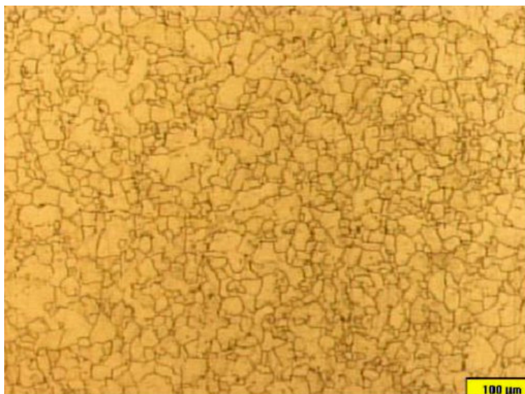
Figura 4.21 Tamanho de grão no núcleo de uma peça da amostra C, aço sem adição de Nióbio utilizando processo II. Tamanho de grão médio ASTM 7,5 - Ataque Ácido Pícrico + Teepol.
