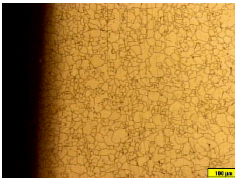
Figura 4.20 Tamanho de grão na superfície de uma peça da amostra C, aço sem adição de Nióbio utilizando processo II. Tamanho de grão médio ASTM 8,0 - Ataque Ácido Pítrico + Teepol.
