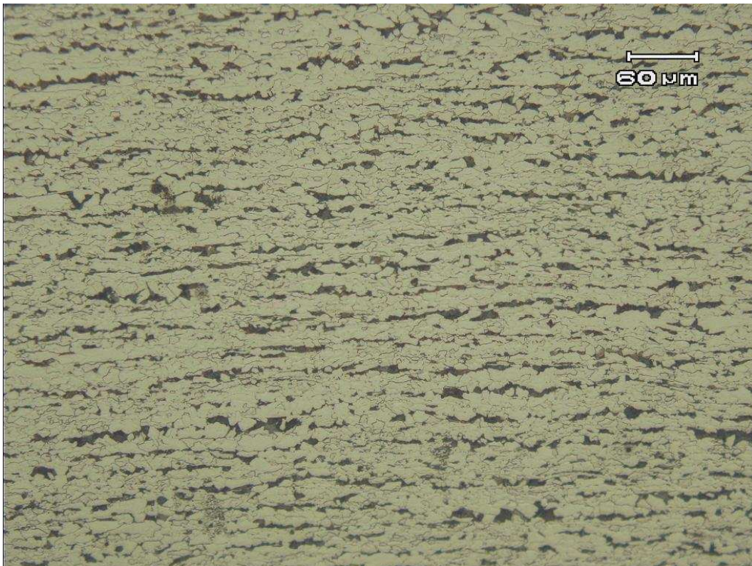
Figura 5.3 Micrografia do material de base da junta estudada. Aumento 200x. Reagente NITAL 2%.
