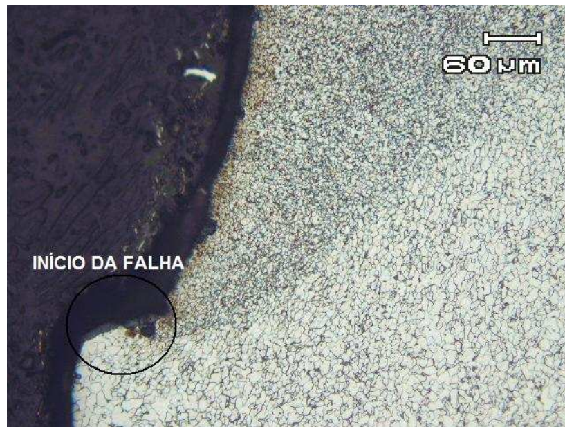
Figura 6.3 Micrografia da região de início da falha (ponto 1 da Figura 6.2). Observa-se a região de maior concentrador de tensões no canto inferior esquerdo, onde ocorreu a nucleação da trinca de fadiga. Aumento 200x. Reagente NITAL 2%.
