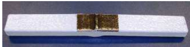
Figura 4.4 Corpos de prova preparados para o ensaio de corrosão fadiga.
