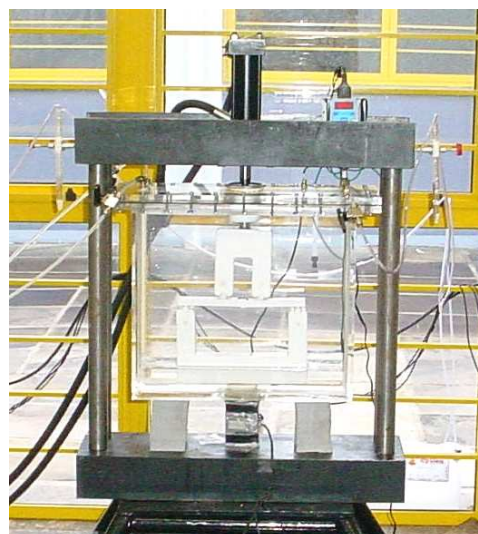
Figura 4.6 Quadro de reação montado para realização de ensaios.
