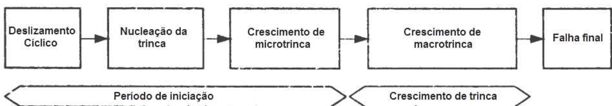
Figura 3.10 Blocos esquemáticos representando as etapas de iniciação e propagação de trincas de fadiga até a falha [35].
