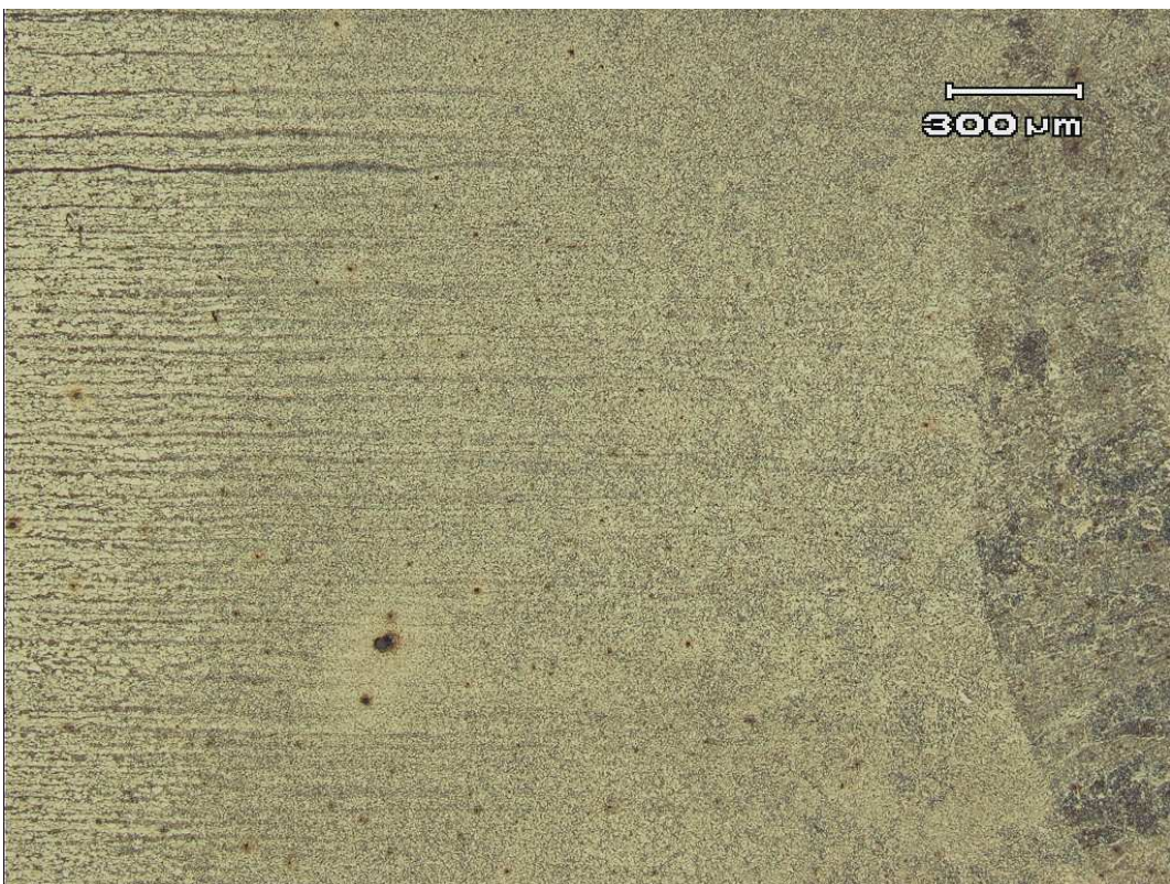
Figura 5.5 Micrografia da zona afetada pelo calor da solda estudada. Aumento de 50x. Reagente NITAL 2%.
