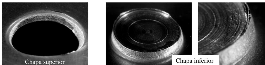
Figura 51. Modo de falha do tipo arrancamento parcial simples ocorrido sob solicitação monotônica de tração em junta FSpW da liga AA6181-T4. (1900 rpm / 3 s).
