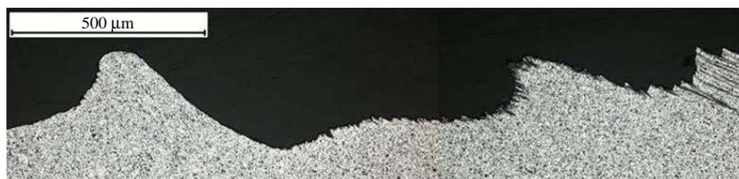
Figura 89. Detalhe do rasgamento da União Secundária em fratura interfacial com trinca circunferencial em ensaio de cisalhamento. (1900 rpm / 2 s).
