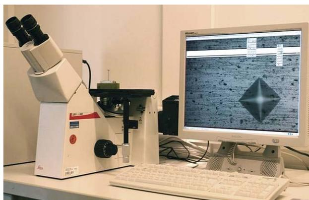
Figura 17. Microscópio óptico Leica DM IRM utilizado nas análises metalográficas.
