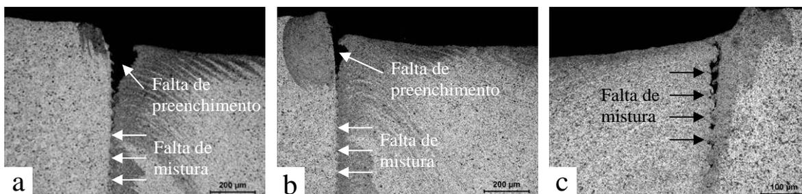
Figura 31. Defeitos encontrados em algumas soldas: (a) condição 32 (2400 rpm / 2 s), (b) condição 38 (2400 rpm / 2,6 s) e (c) condição 35 (2900 rpm / 2,2 s).
