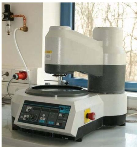
Figura 16. Máquina de lixamento e polimento automático modelo Buehler Phoenix 4000 utilizada na preparação metalográfica.
