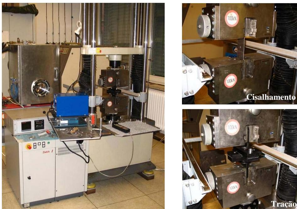
Figura 15. Máquina de tração Schenck-Trebel RM100 utilizada para a avaliação da resistência mecânica das juntas soldadas sob solicitação de cisalhamento e de tração.
