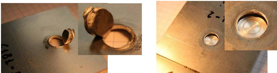
Figura 55. Fratura em fadiga de baixo ciclo (alto nível de carregamento) ocasionada pela nucleação e propagação de trinca circunferencial no entorno do botão de solda.
