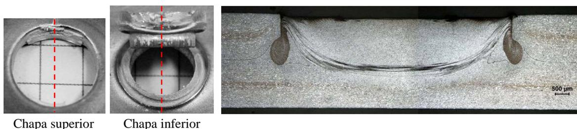
Figura 81. Fratura do tipo arrancamento total/botão na chapa inferior sob solicitação de cisalhamento. Solda produzida com 2900 rpm / 2 s.
