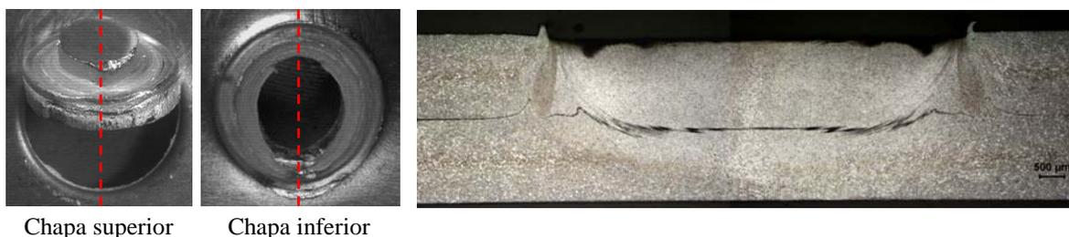
Figura 76. Fratura do tipo arrancamento total/botão na chapa superior em solda FSpW da liga AA6181-T4. Solda produzida com 2400 rpm / 3 s.
