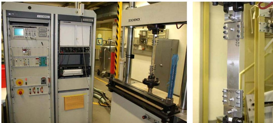
Figura 19. Máquina servo-hidráulica Schenck Trebel RM 50 utilizada nos testes de fadiga.
