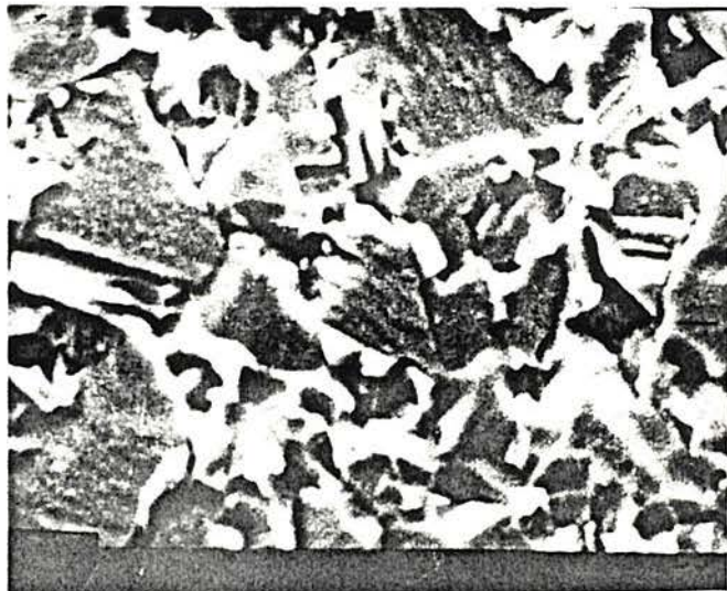
Figura 6.6 - Metal duro, classe NHA visualizado ao MEV-Microscópio Eletrônico de Varredura com aumento de 10000 X. Ataque eletrolítico (KOH).
