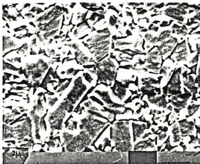
Figura 6.4 - Metal duro, classe HA visualizado ao MEV- Microscópio Eletrônico de Varredura com aumento de 10000 X. Ataque eletrolítico (KOH).
