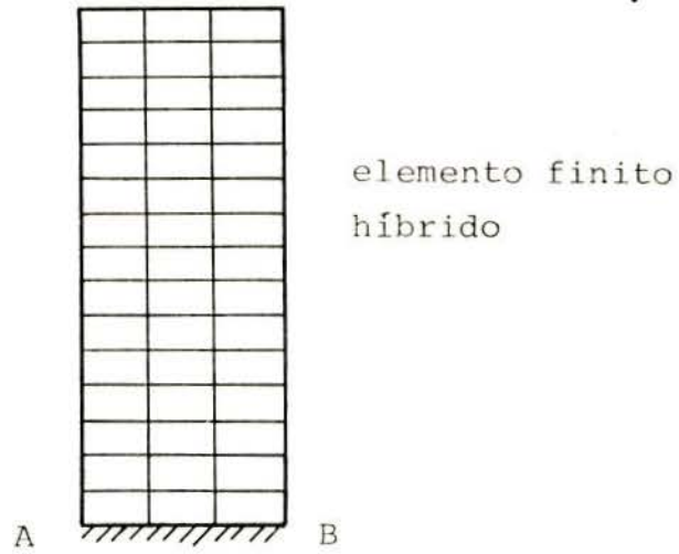
FIGURA 89 - Malha de elementos finitos para o exemplo 1
