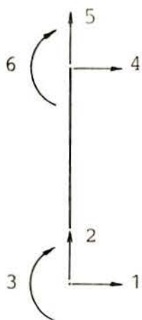
FIGURA 41 - Representação de uma "par. Res." c/ 6 graus de liberdade
