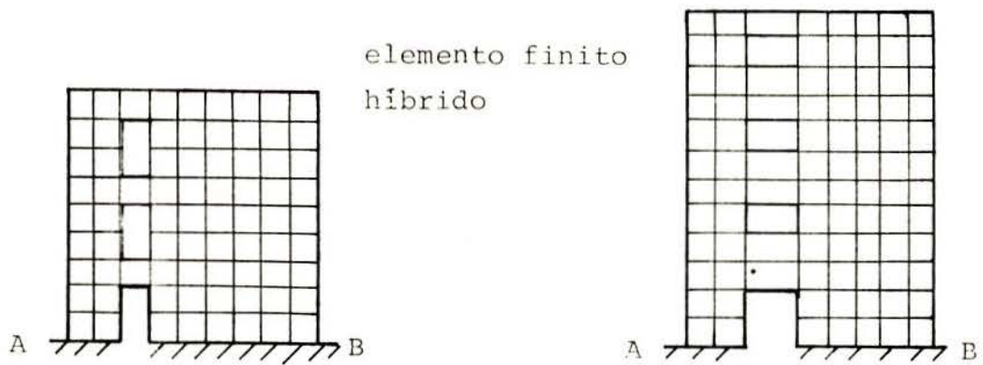
FIGURA 91 - Malha de elementos finitos para o exemplo 3
