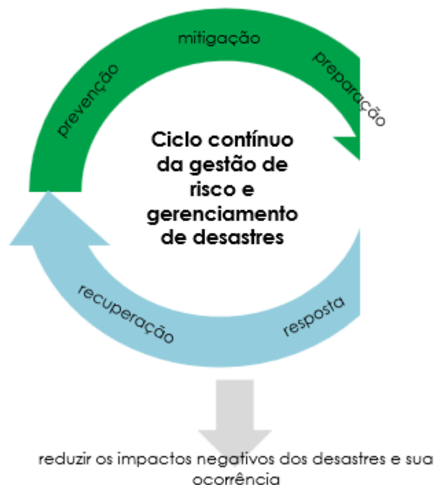
Figura 4 – Esquema que apresenta as fases da gestão de riscos e de desastres em um ciclo contínuo
