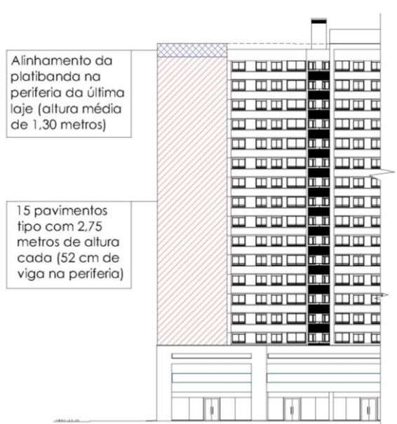
Figura 20 - Trecho de fachada com indicação dos setores utilizados na extração de quantitativos
