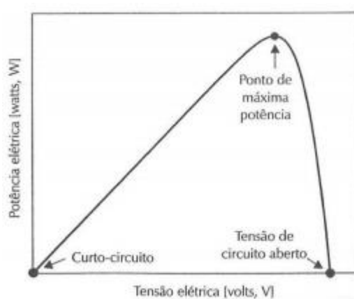
Figura 5: Curva característica da potência elétrica fornecida por um módulo fotovoltaico de silício cristalino (c-Si) em função da tensão elétrica (Fonte: Adaptado de ANDRADE, 2015)
