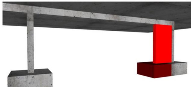
Figura 11 - Construção de parede de concreto armado, incluindo o reforço da fundação
