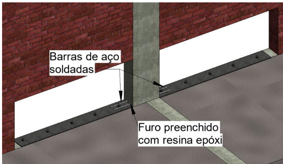
Figura 37 – Barras de aço soldadas na chapa
