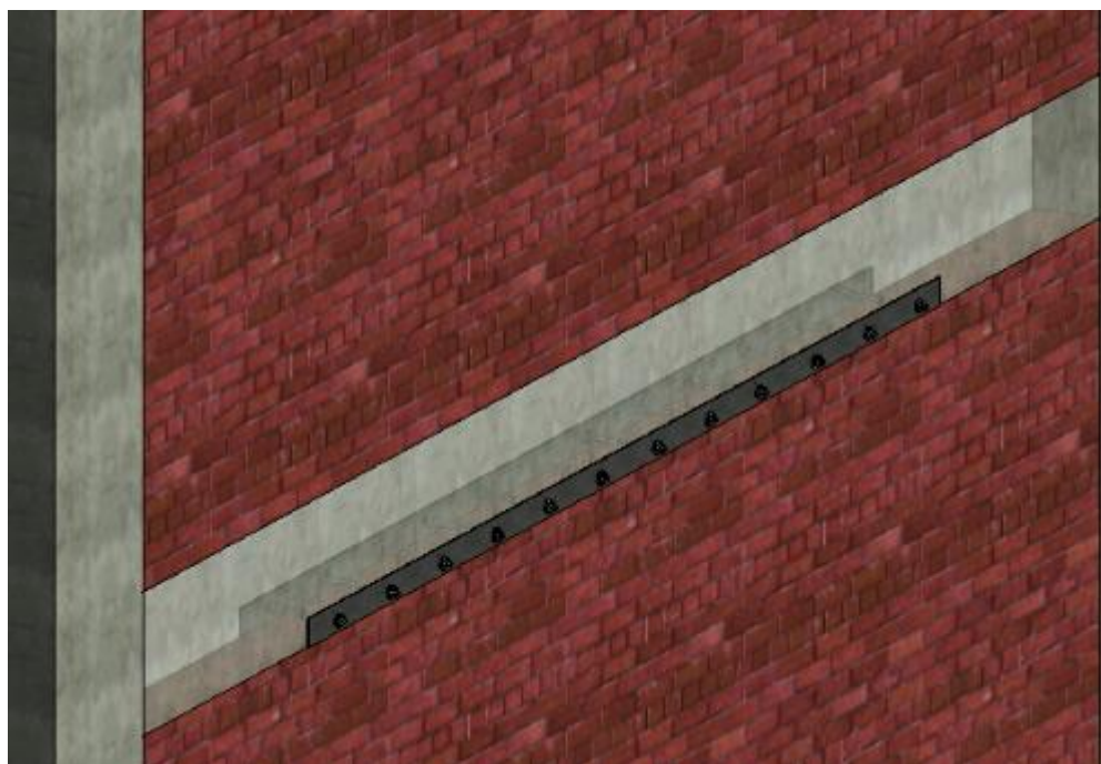
Figura 46 – Reforço com chapa de aço nas laterais da viga
