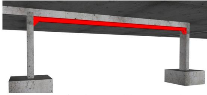
Figura 10 - Montagem de viga metálica para reforço da viga existente
