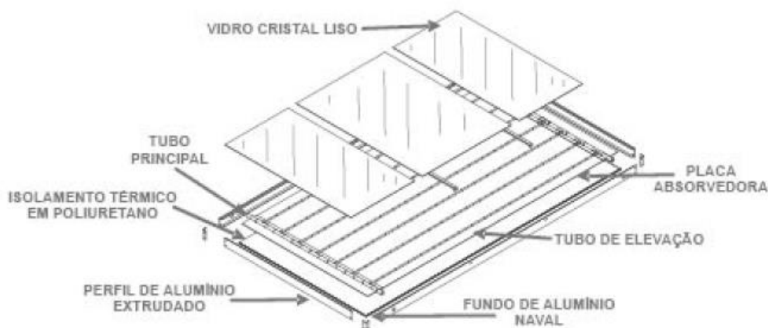
Figura 26 – Componentes do coletor solar
