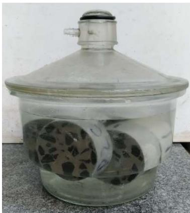
*Figura 22: Corpos de prova imersos em água deionizada e deaerada*
