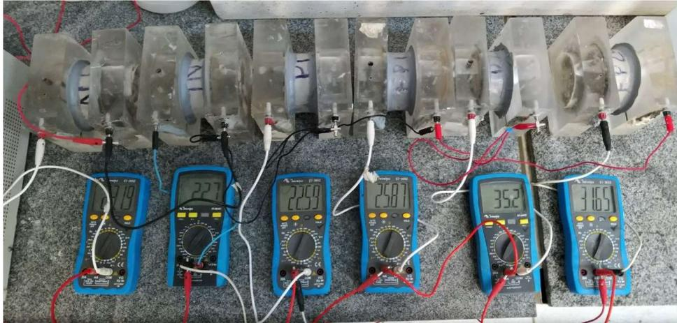
Figura 27: Medições de corrente elétrica em cada uma das células dada pelos multímetros em miliAmpère (mA)
