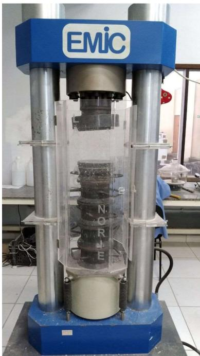
Figura 17: Prensa hidráulica utilizada para realização do ensaio de compressão uniaxial
