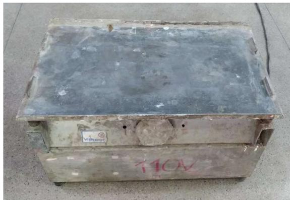
Figura 14: Mesa vibratória utilizada para o adensamento do concreto fresco no interior dos moldes
