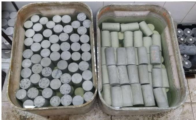
Figura 16: Tanques de cura por submersão contendo água saturada de cal
