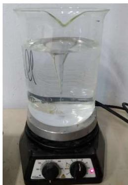
*Figura 24: agitador magnético utilizado para homogeneização das soluções de NaOH e NaCl*
