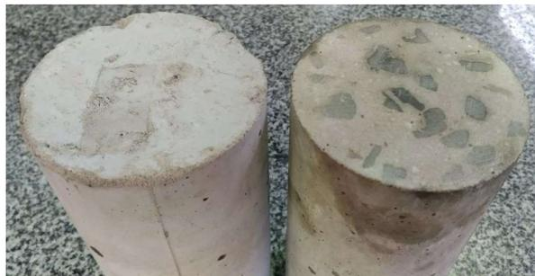
Figura 18: Base do corpo de prova antes (esquerda) e depois (direita) de retificados
