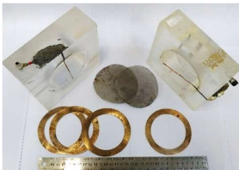
*Figura 23: Conjunto utilizado na montagem da célula de ensaio: blocos de acrílico com cavidade para colocação das soluções de NaCl e NaOH, anéis de cobre e telas metálicas*
