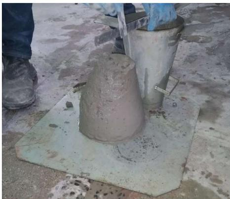
Figura 12: Execução do ensaio de abatimento de tronco de cone e aspecto visual do concreto no estado fresco
