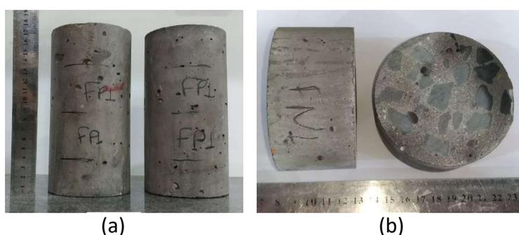
Figuras 20: Identificação e demarcação das fatias internas a serem cortadas (a); amostras após o corte em fatias de  $51 \pm 3$  mm de espessura para realização do ensaio de penetração de íons cloreto (b)
