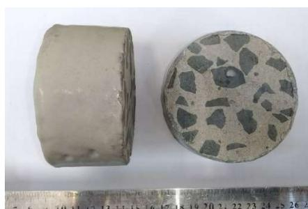
Figura 21: Exemplo de amostras de concreto após impermeabilização da superfície lateral com resina epoxídica
