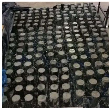
Figura 15: Cura inicial dos concretos sobre superfície plana rígida
