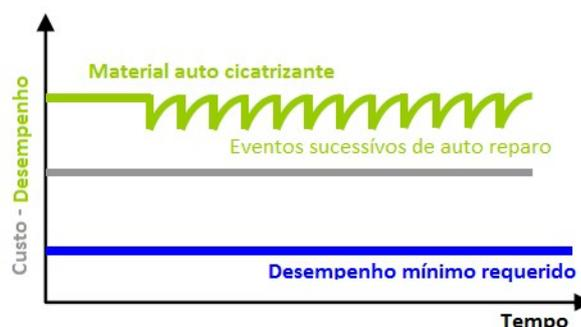
Figura 5: Desempenho e custo em função do tempo para estruturas construídas com material autocicatrizante. (adaptado de VAN BREUGEL, 2007)
