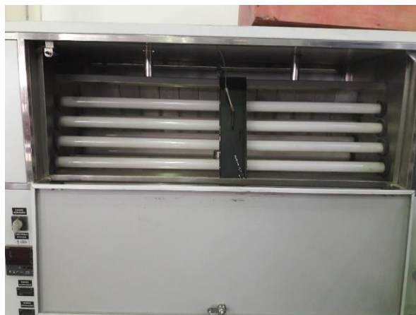
Figura 20 - Câmara de envelhecimento acelerado: (a) disposição das lâmpadas e (b) disposição dos cp's
