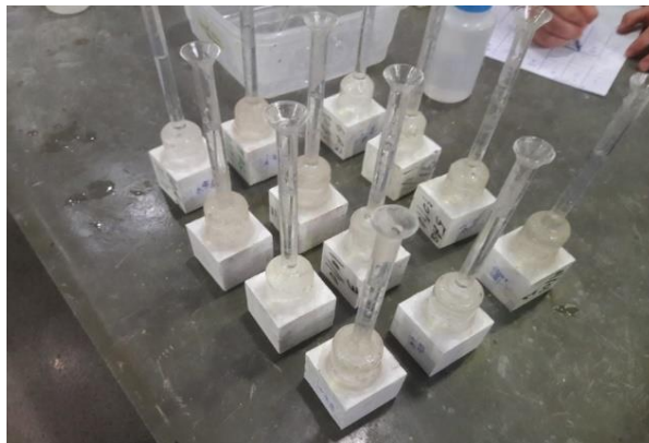
Figura 15 – Ensaio de permeabilidade em andamento
