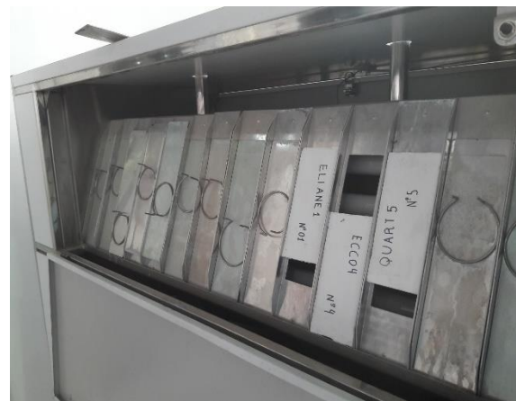
Figura 20 - Câmara de envelhecimento acelerado: (a) disposição das lâmpadas e (b) disposição dos cp's
