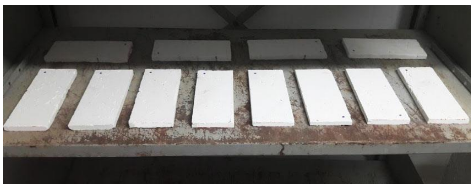
Figura 17 – Placas em repouso na câmara climatizada
