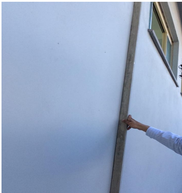
Figura 19 - Foto dos Instrumentos Utilizados, Régua Plana de alumínio
