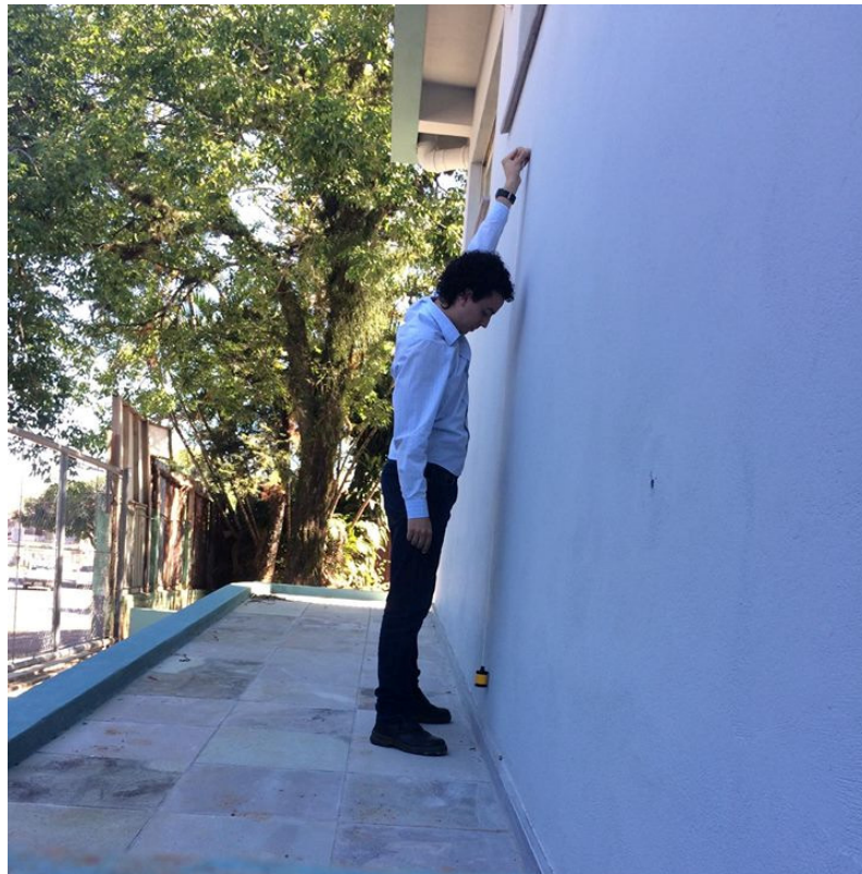
Figura 24 - Foto Aplicação Instrumento de Verificação Prumo
