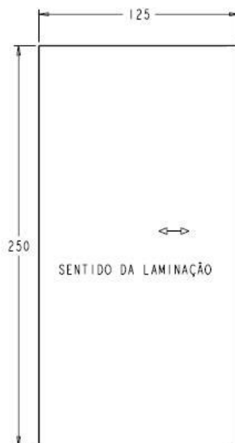
Figura 17 - Dimensões em milímetros do corpo de prova para confecção das juntas soldadas
