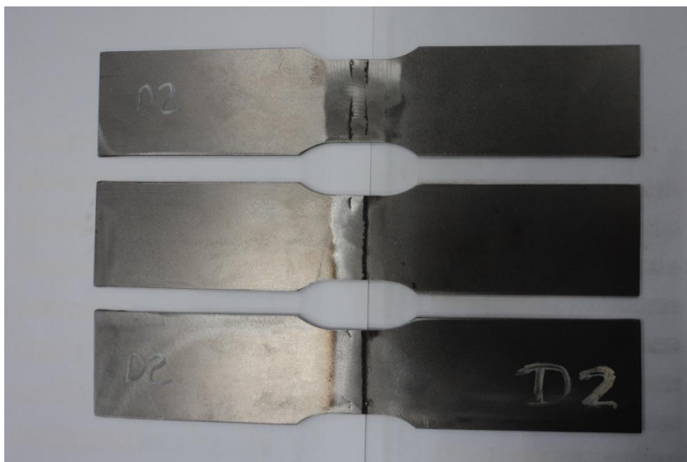
Figura 35 - Corpos de prova confeccionadas a partir da chapa soldada utilizando aporte térmico do corpo de prova D2
