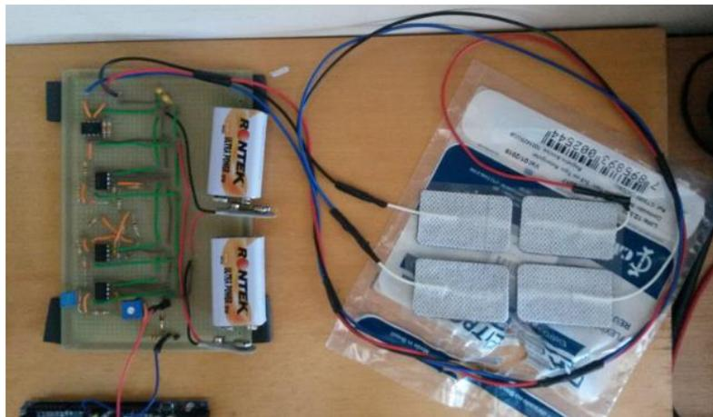
Figura 14: Placa de Eletromiografia montada.
