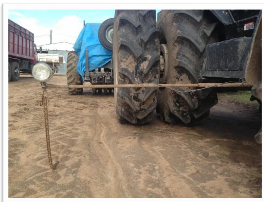
Figura 3: Marcador de linha equipado com luz para semeadura noturna, Fazenda Cavahada, Mostardas/RS.
