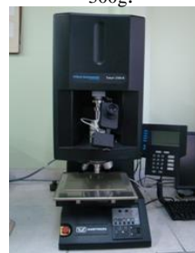
Figura 6 – Microdurômetro marca Instron na escala HV com carga de 300g.
