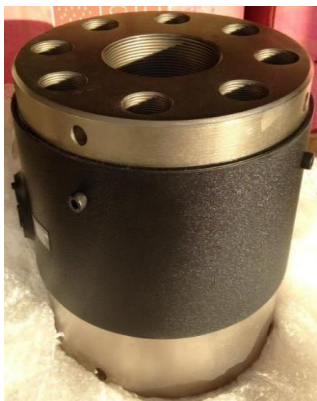
Figura 17 – Célula de carga utilizada é da marca KRATUS com capacidade de 3000 kN.
