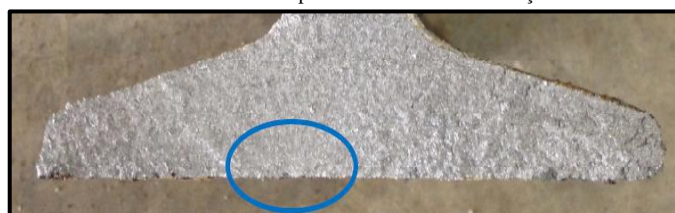
Figura 31 – Imagem da superfície de fratura – Amostra 02B, após o ensaio de flexão estático. Elipse indica o local de iniciação da falha.
