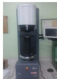
Figura 3 – Durômetro digital Dura Vison 30, modelo DV30 para faixas de 120 a 510 HBW 10/3000 (Brinell).
