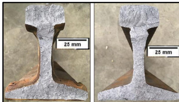
Figura 33 – Imagens da superfície de fratura – Amostra 03A, após o ensaio de flexão estática
