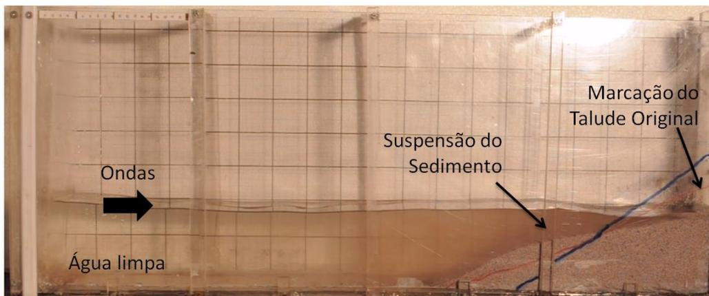
Figura 3 – Registro do final Experimento 3, onde não ocorreu a formação de FGSSO, apesar da suspensão do sedimento junto ao talude (fonte: autoria própria).
