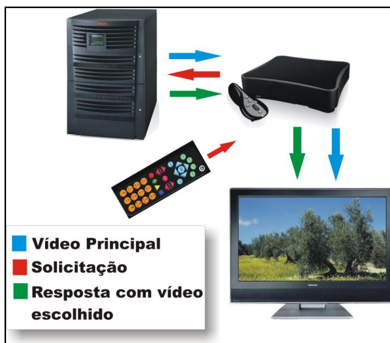
Figura 36: Esquema de funcionamento da transmissão do vídeo.
