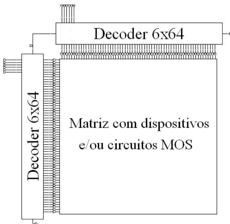
Figura 3.1: Diagrama de blocos dos decodificadores de endereços de linhas e de colunas ( Decoder 6X64 ) e da matriz de dispositivos e/ou circuitos MOS.
