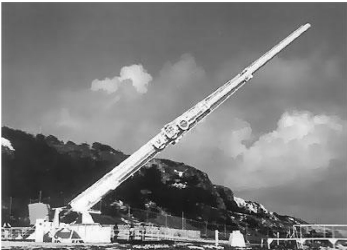
Fig.72. Fotografia do canhão de testes do projeto HARP, idealizado por Gerald Bull na década de 1960 85 .
