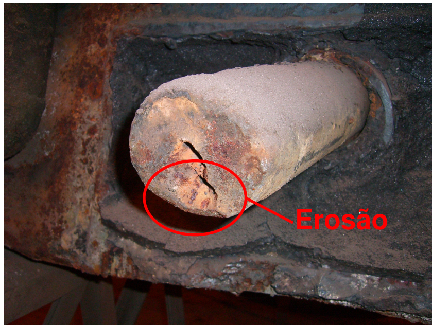
Figura 45 – Injetor Multi Point Double Flow (MPDF) com erosão no bico, causado pelo jato subacelerado, na pressão abaixo de 9,0 \text{ kgf/cm}^2 .
