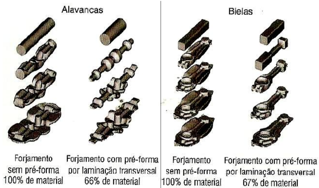
Figura 2.28 – Economia de material que pode ser obtida com o uso de pré-formas.
