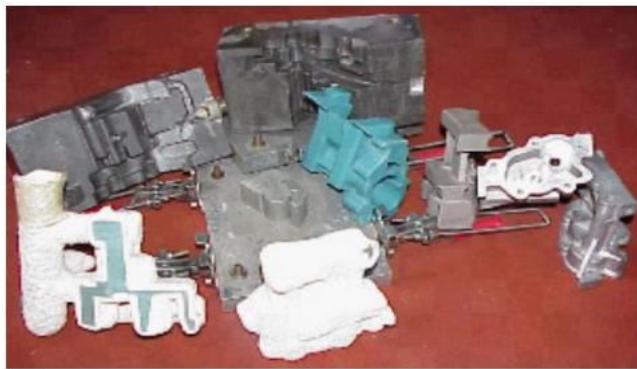
Figura 2.30 – Moldes em resina e protótipos em cera, cerâmica e metálicos. Fonte: [Lino et al., 2006, p. 4].
